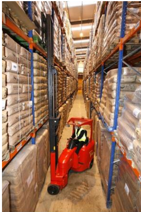
Slika 3.3.: Viličar sa zakretnim jarbolom (Flexi AC 1000/1100) [20]
