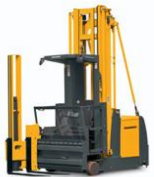
Slika 4.7.: EKX 410 visokoregalni viličar sa zakretnim vilicama i komisioner [10]
