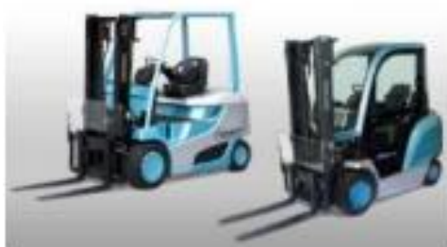
Slika 2.5.: Toyota – hibridni viličari na vodik [17]
