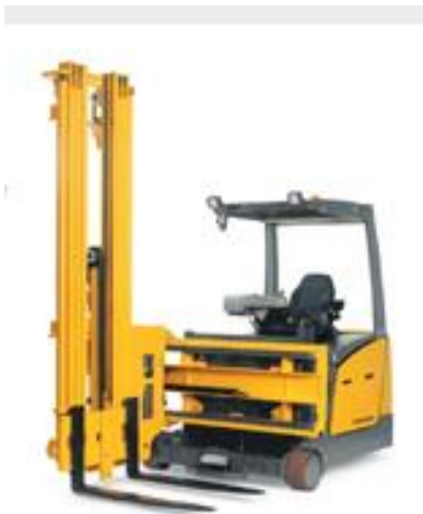
Slika 4.6.: EFX 410-413 viličar sa zakretnim vilicama [11]
