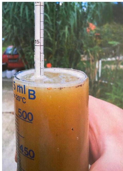
Slika 14. Izmjera šećera u moštu nakon maceracije
