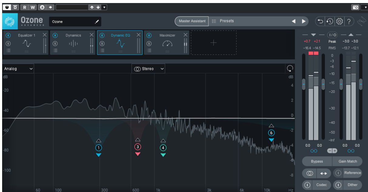
Slika 33: Dinamička EQ obrada u Ozone 9 plug-in-u
