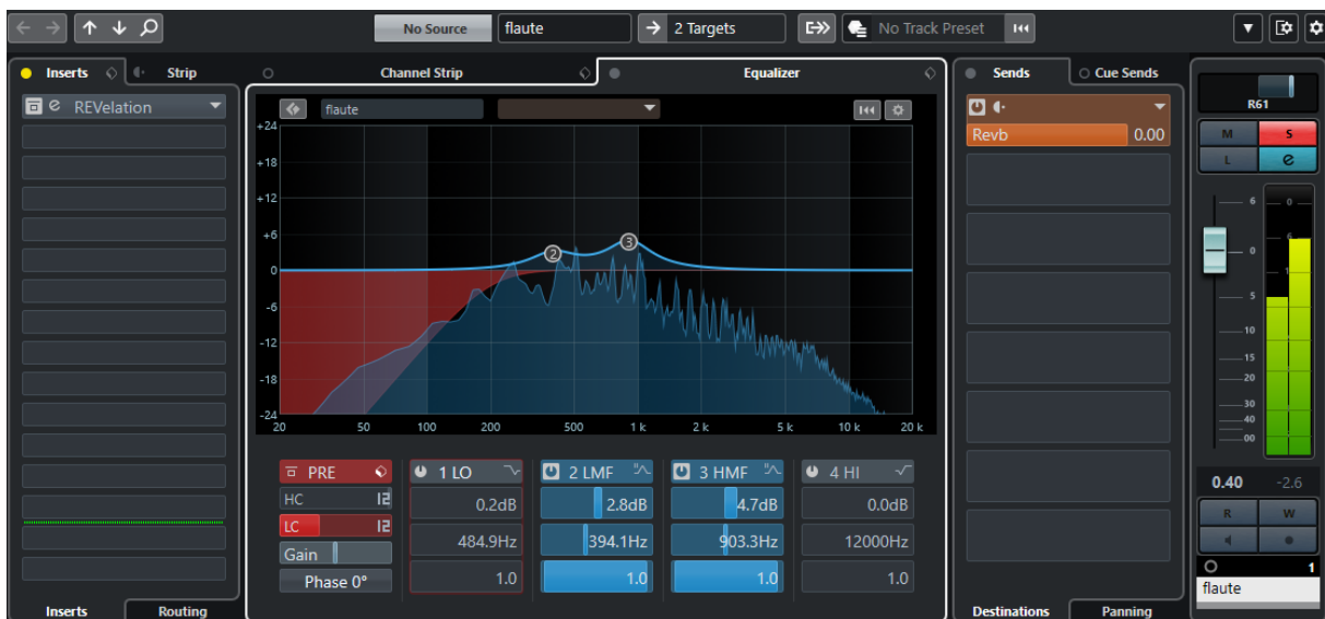
Slika 27: Postavljanje low cut filtera i isticanje određenih frekvencija za kanal s flautama
