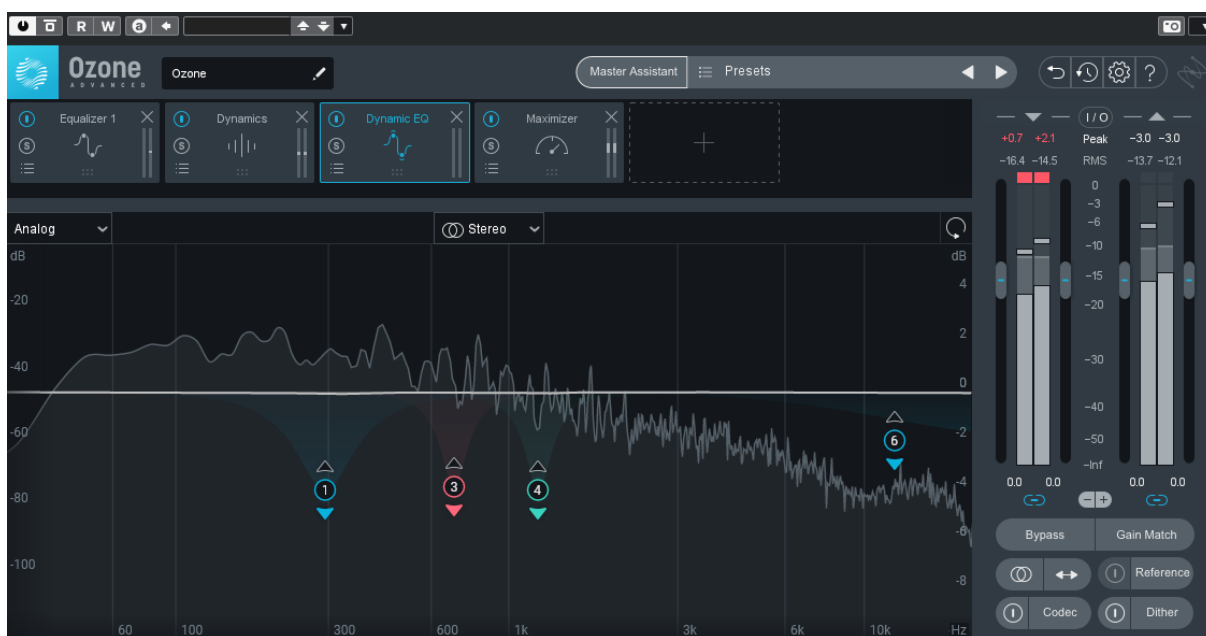
Slika 33: Dinamička EQ obrada u Ozone 9 plug-in-u
