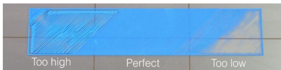
Slika 5.2.3 Udaljenost od podloge: prevelika (lijevo), ispravna (sredina), premala (desno)
