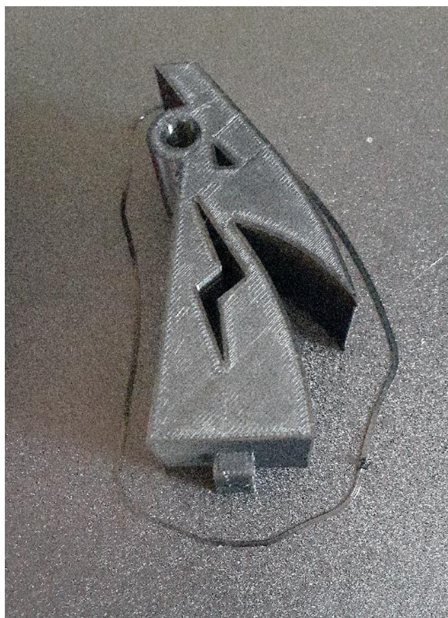
Slika 7.17 3D ispisani bazni dio luka
