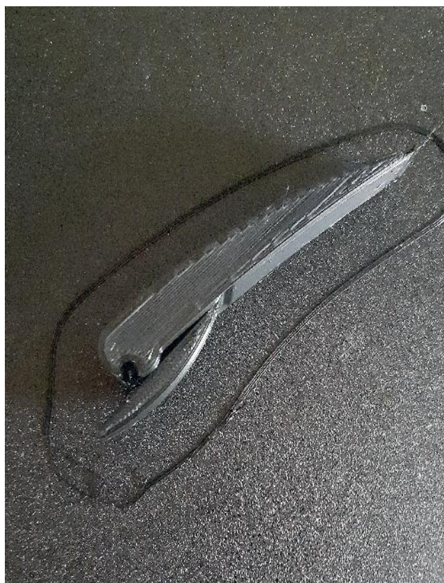
Slika 7.19 3D ispisani vršni dio luka
