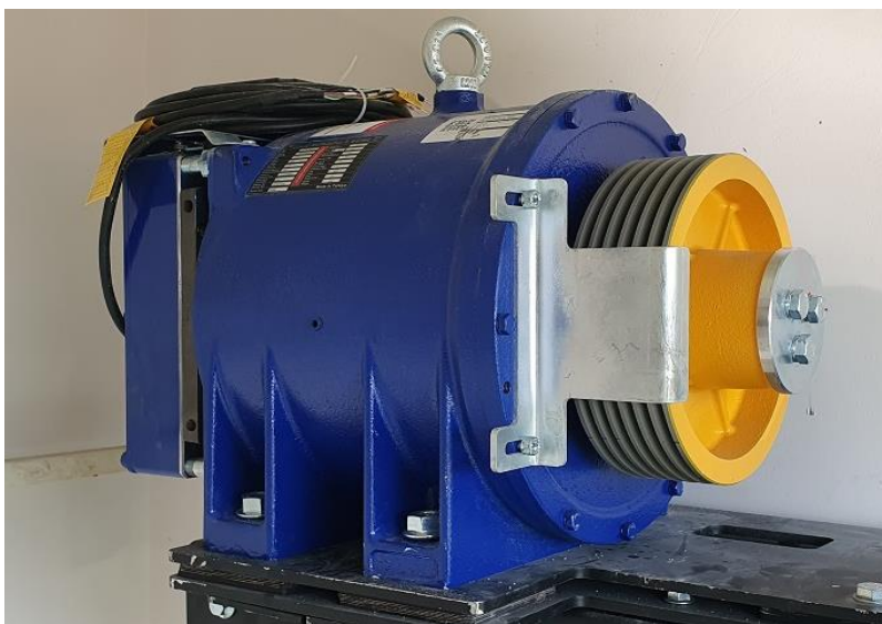
Slika 7. Sinkroni motor s permanentnim magnetima
