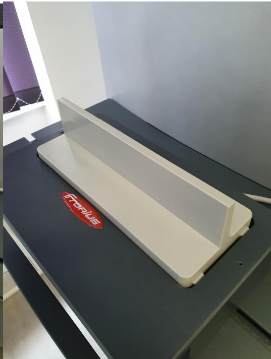
Slika 30. Ploča za vježbanje kutnog zavarava - obrada
