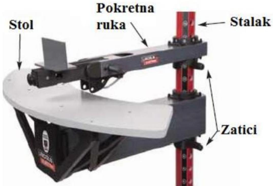
*Slika 13. Dijelovi stalka [7]*
