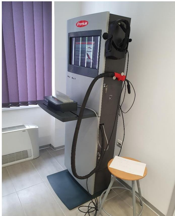
*Slika 1. Simulator za zavarivanje Fronius Virtual Welding 2.0, (eng. Stand Up terminal) - obuka*
