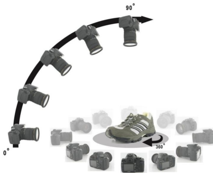
Slika 7. Fotografiranje proizvoda na više osi.
