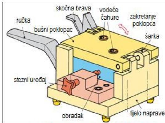
*Slika 3 Naprava s zakretnim bušenim poklopcom [5]*
