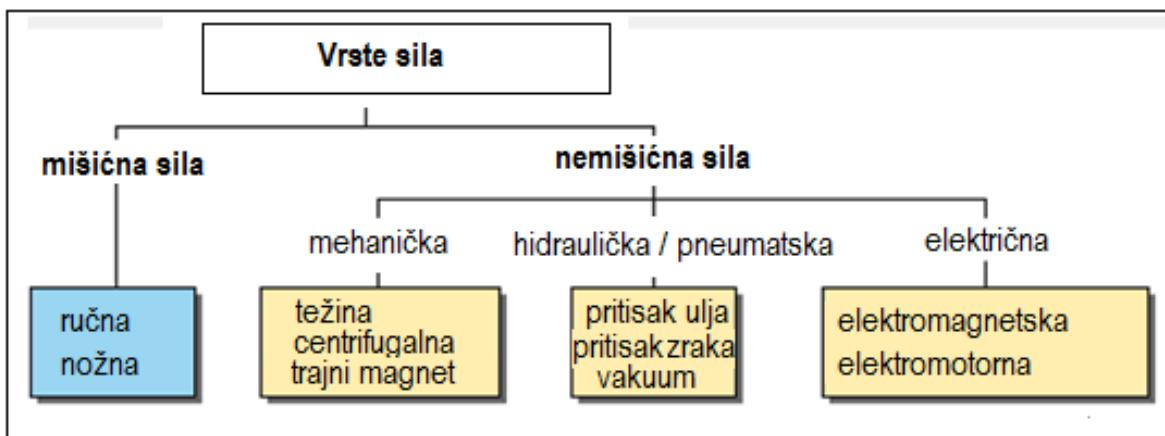
Slika 7 Vrste sile stezanja prema načinu proizvodnje [5]
