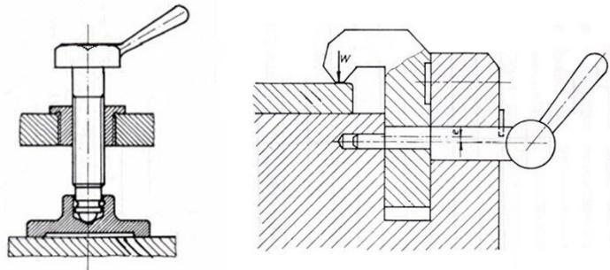
Slika 8 Stezanje vijkom i kružnim ekscentrom [7]
