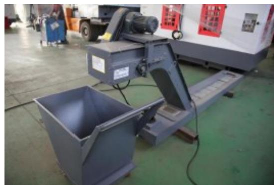
Slika 20 Transporter za uklanjanje strugotine [10]
