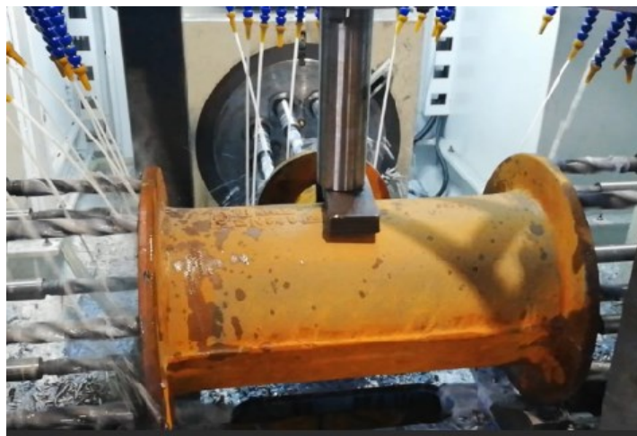
Slika 85 Stezanje komada hidrauličkim cilindrom
