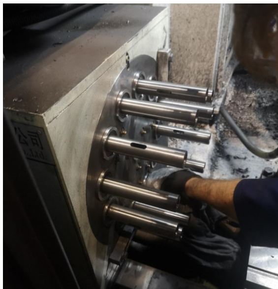
Slika 73 Čišćenje glave za bušenje
