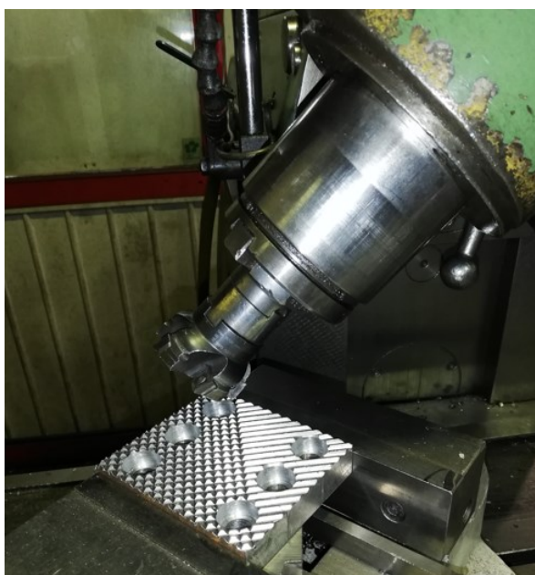
Slika 68 Glodanje kanala na čeljustima
