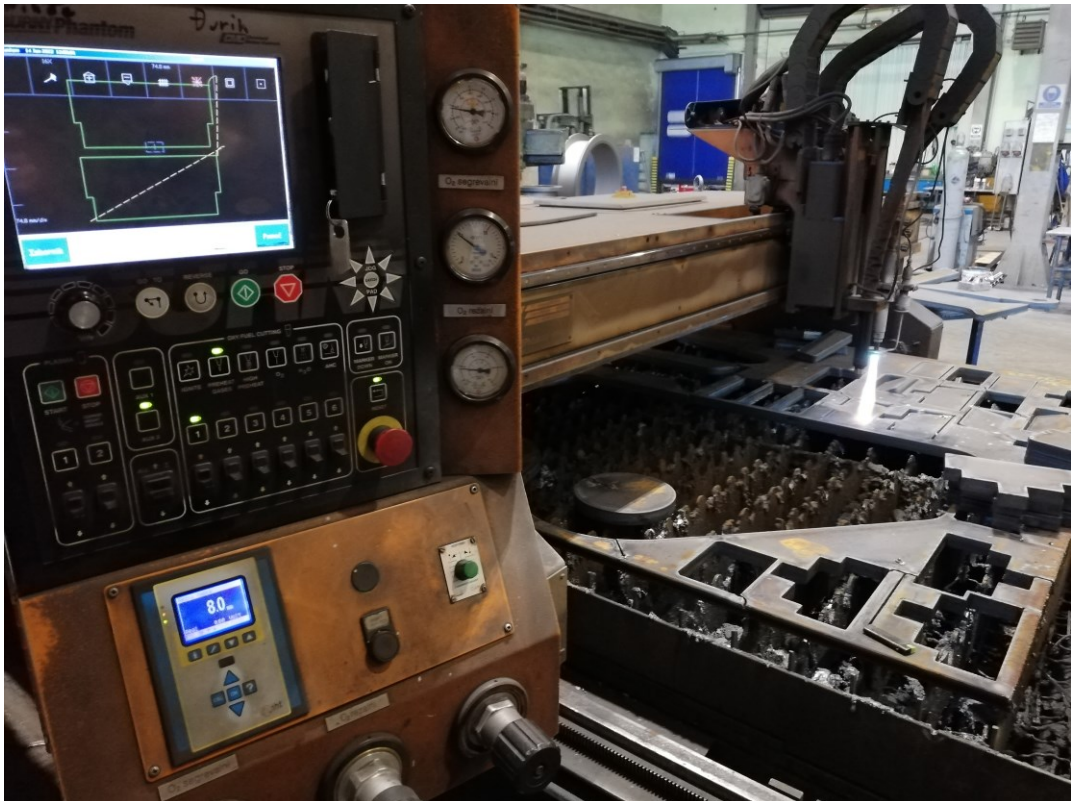
Slika 47 Rezanje ploče na plazma rezaču
