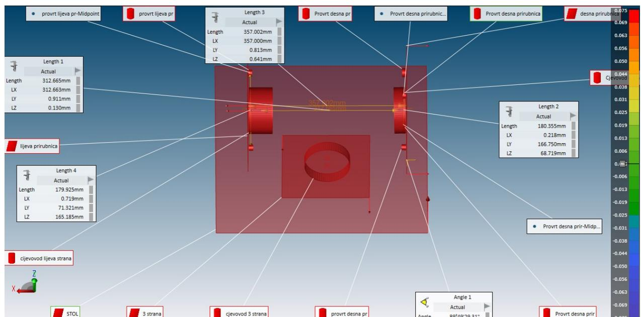
Slika 93 Podaci skeniranog T komada
