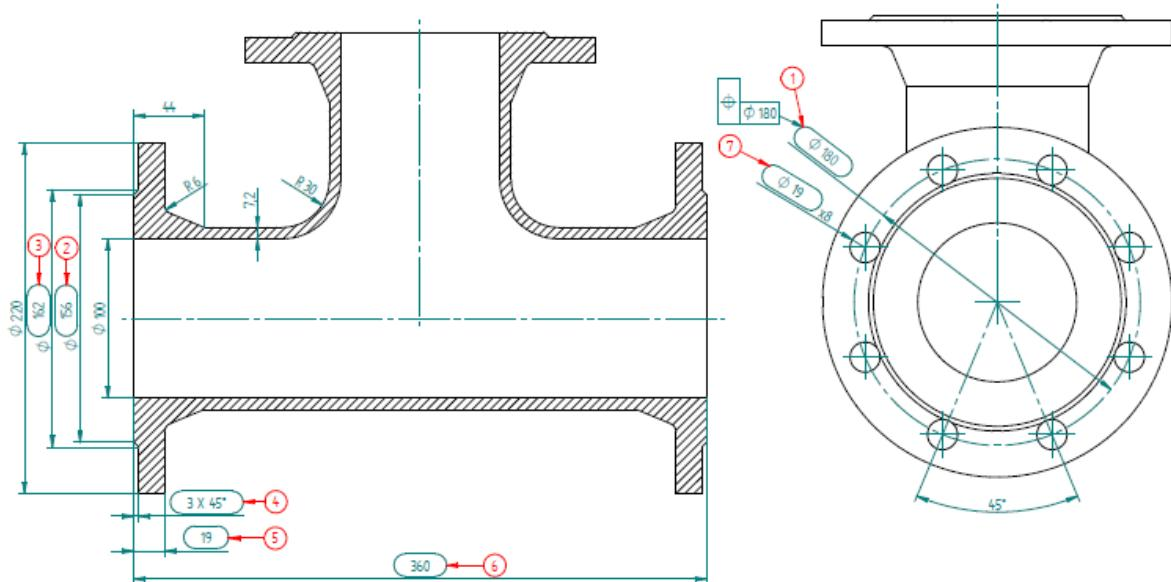
Slika 94 Dimenzijske T komada prema HRN EN 1092-2
