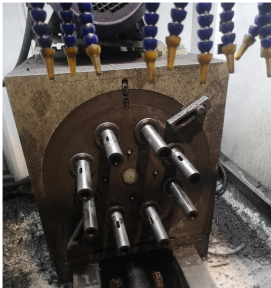
Slika 71 Glava za bušenje prije čišćenja
