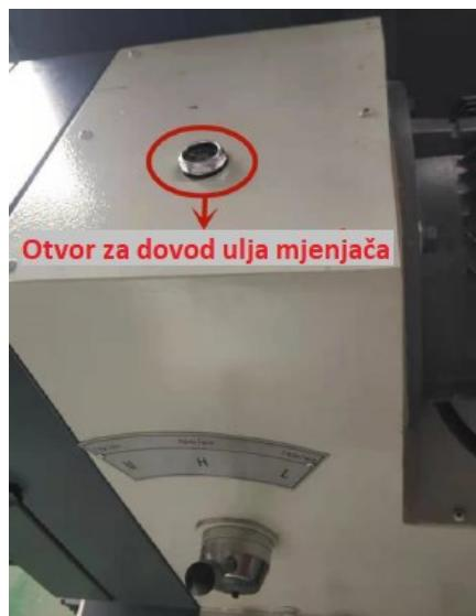
Slika 23 Dovod ulja mjenjača [10]
