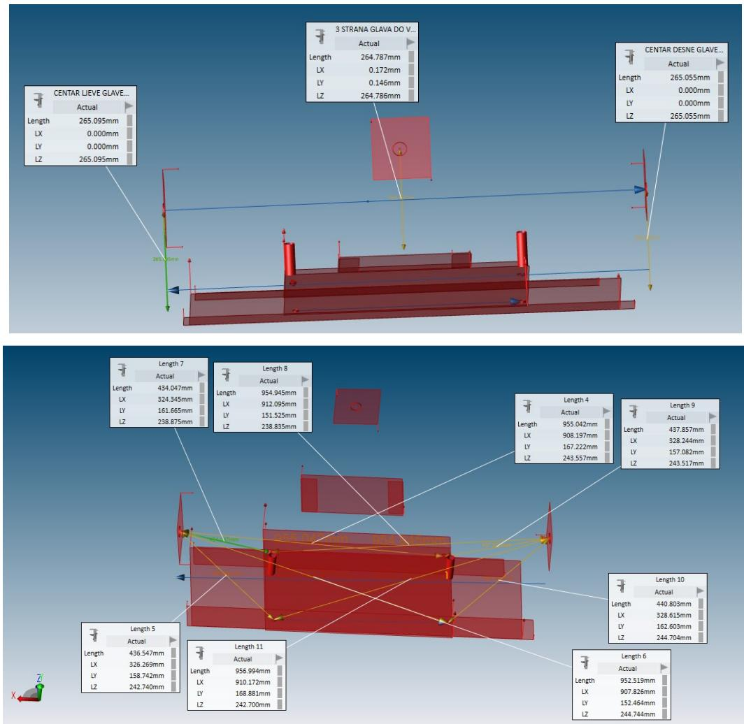
Slika 29 Izmjerene udaljenosti centra lijeve i desne glave
