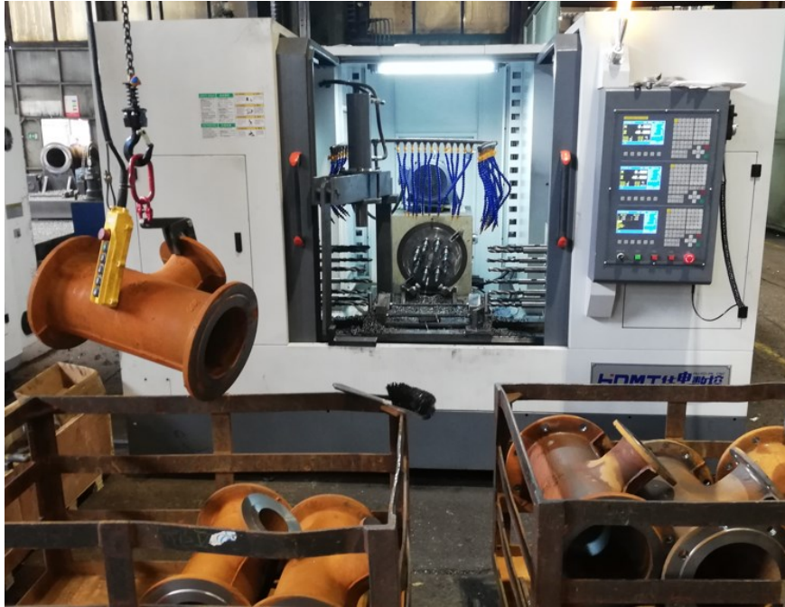
Slika 84 Dizanje komada dizalicom
