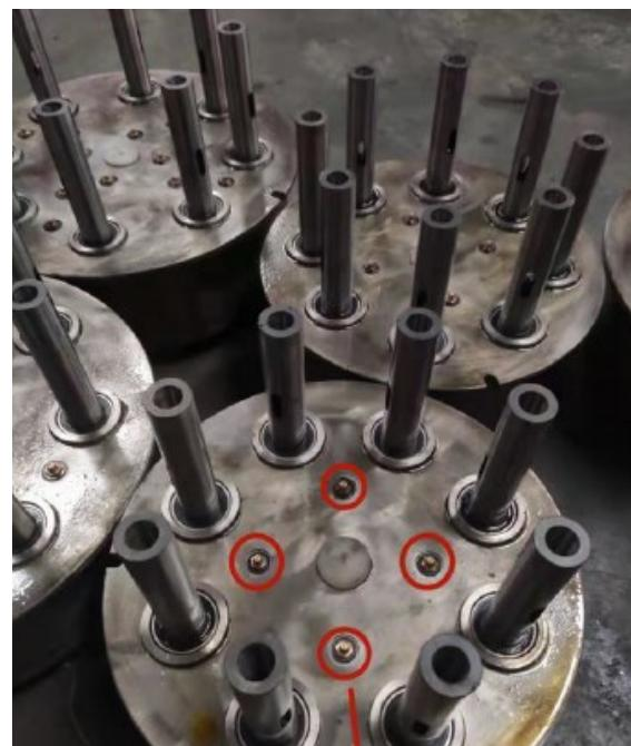
Slika 26 Podmazivanje glave za bušenje [10]
