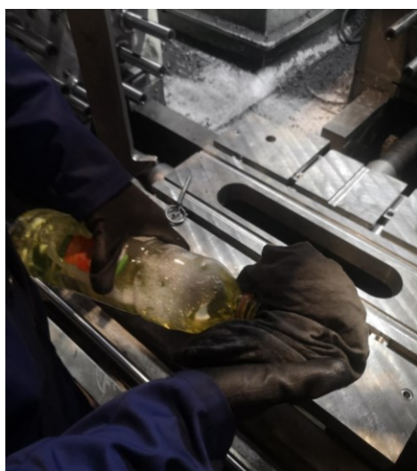
Slika 72 Nanošenje sredstva za čišćenje na krpu
