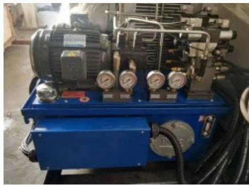
Slika 18 Hidraulična stanica [10]
