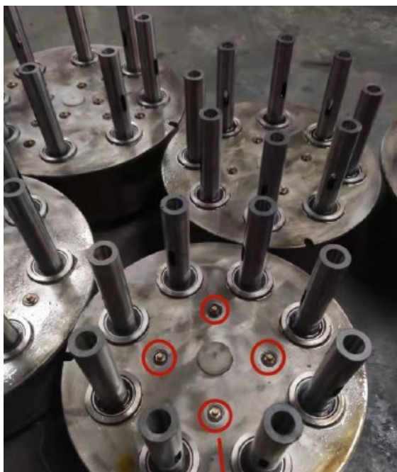
Slika 26 Podmazivanje glave za bušenje [10]
