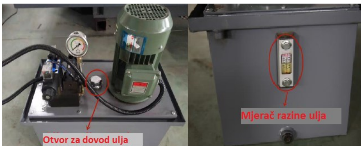
Slika 25 Dovod ulja hidrauličke stanice [10]
