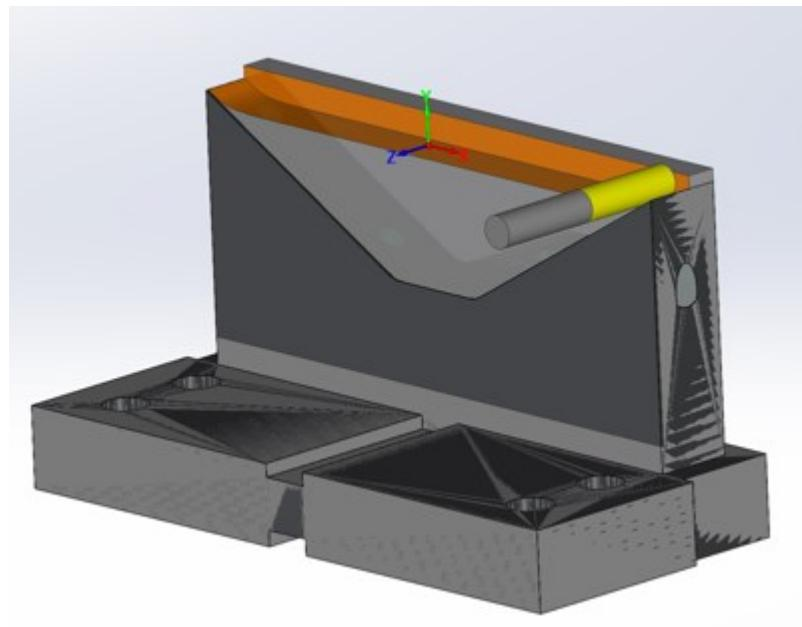
Slika 54 Simulacija grube obrade
