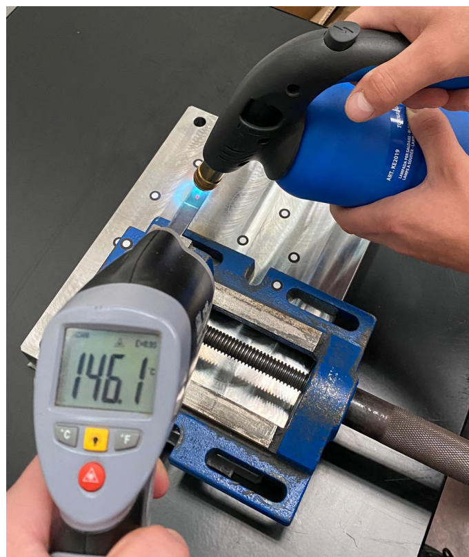
Slika 48: Lokalno zagrijavanje i mjerenje temperature [Varaždinske Toplice, 19. 8. 2022.]
