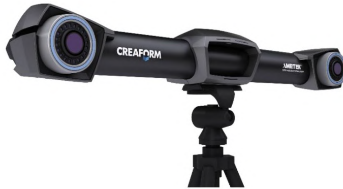
Slika 2: Creaform C-Track - primjer pasivne mjerne metode [3]
