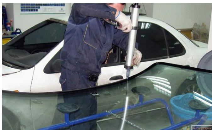
Slika 18. Primjer lijepljenja vjetrobranskog stakla [16]
