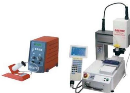
Slika 14. Poluautomatski uređaj i robot za nanošenje ljepila [5]
