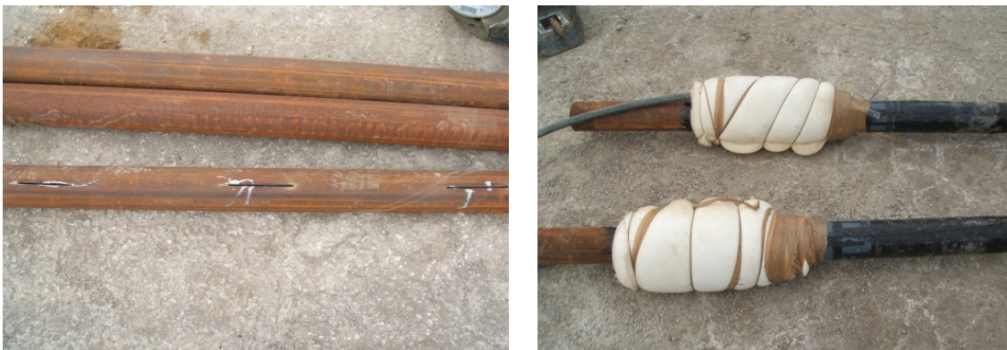
Slika 3.2.1.2. Perforirane čelične cijevi ; Brtva sa spojem čelične i okiten cijevi
