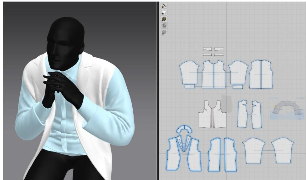
Slika 25 Prikaz 2D uzorka digitalne odjeće i 3D simulirane digitalne odjeće u programu Marvelous Designer
