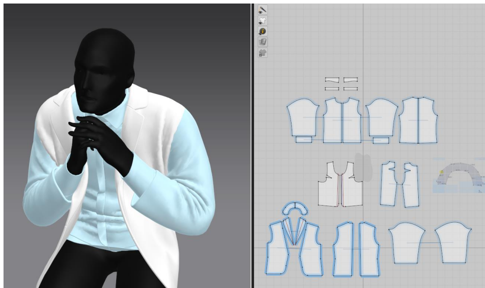
Slika 25 Prikaz 2D uzoraka digitalne odjeće i 3D simulirane digitalne odjeće u programu Marvelous Designer
