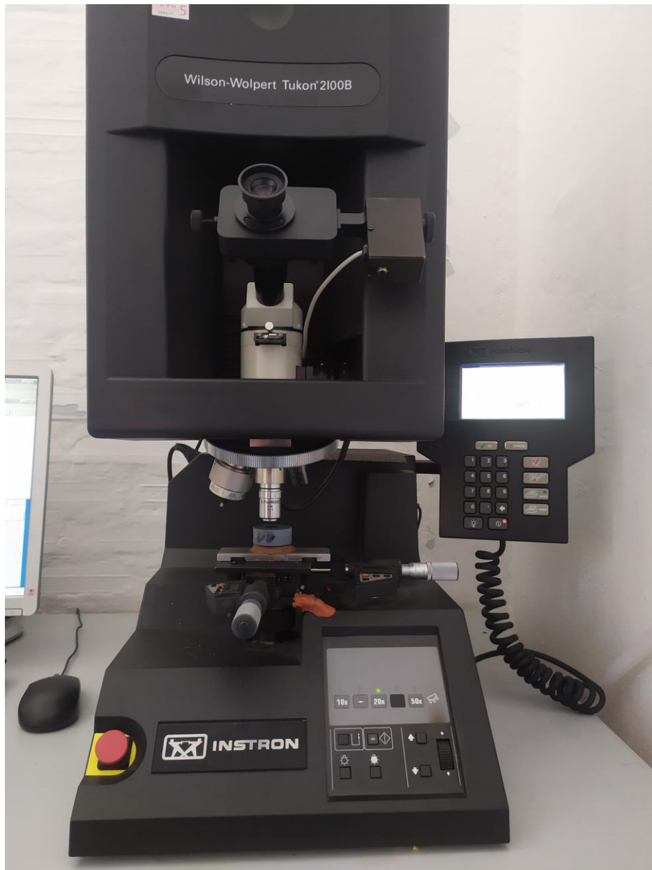
Slika 38. Tvrdomjer s postavljenim uzorkom
