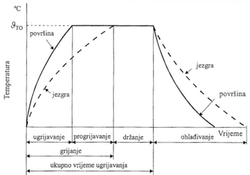
Slika 1. Općeniti dijagram postupka toplinske obrade [1]
