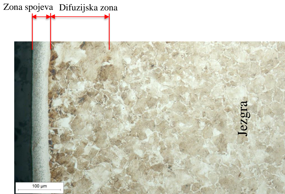
Slika 43. Mikrostruktura uzorka obrađenog Tenifer QP postupkom (uvećanje 200x)
