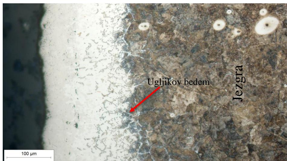
Slika 44. Mikrostruktura uzorka boriranog u čvrstom sredstvu EKABOR 3
