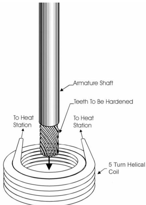
Slika 16. Indukcijsko kaljenje vratila [12]
