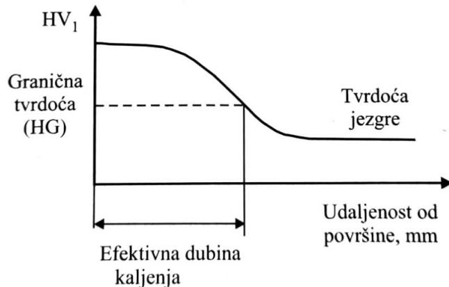
Slika 17. Određivanje efektivne dubine induktičkog kaljenja
