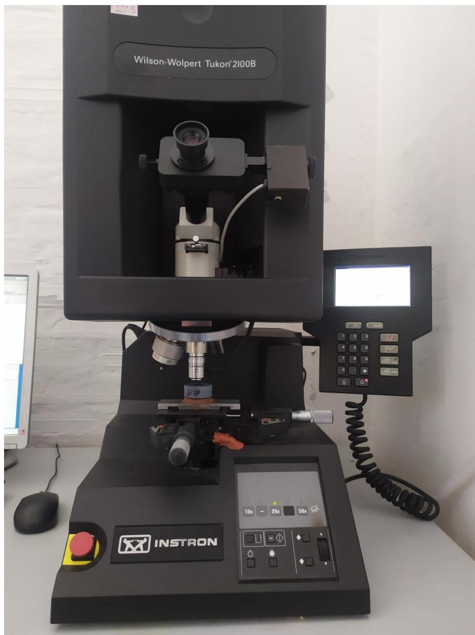
Slika 38. Tvrdomjer s postavljenim uzorkom
