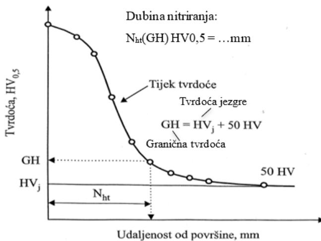
Slika 19. Dobivanje efektivne dubine nitriranja ( $N_{ht}$ ) [11]
