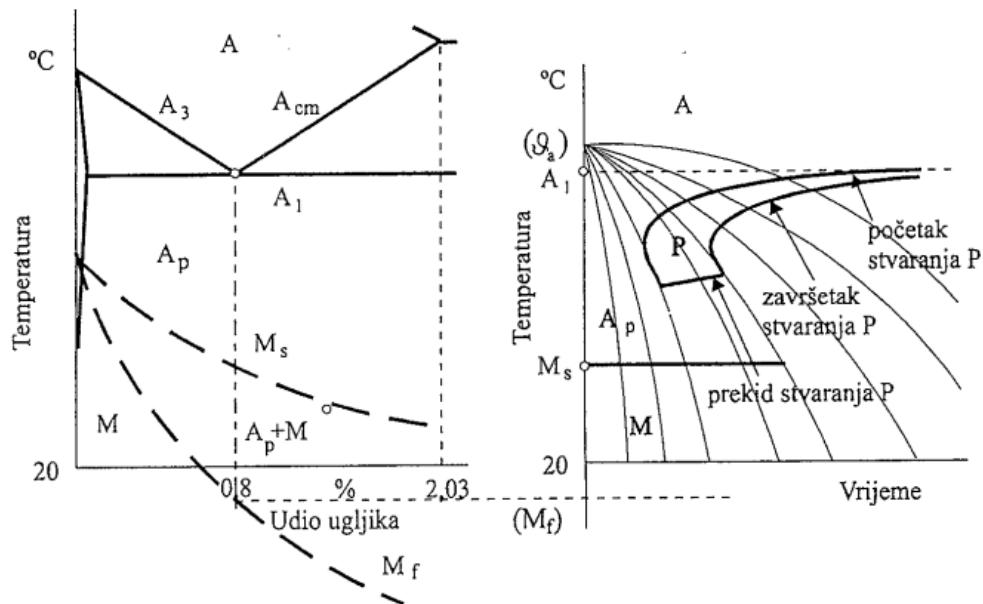
Slika 8. Primjer TTT dijagrama (kontinuiranog) za eutektoidni čelik [1]
