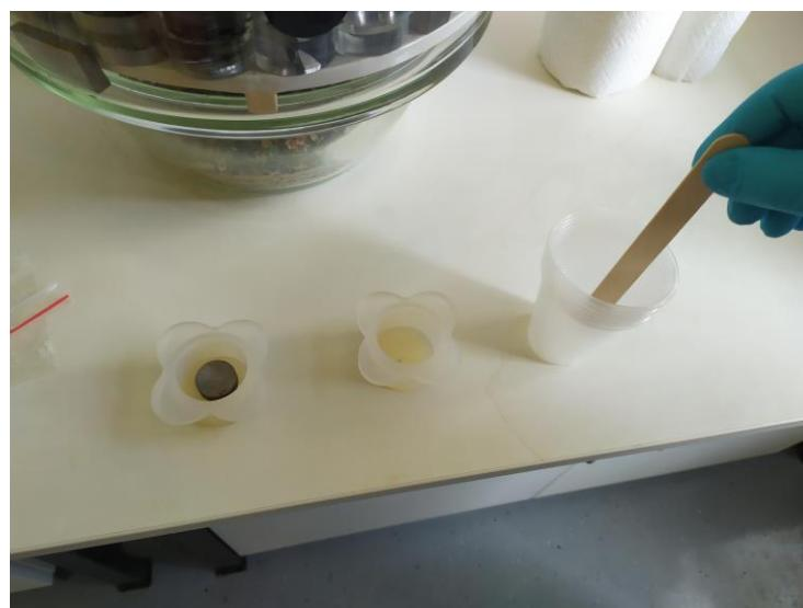
Slika 27. Pozicioniranje uzorka i ulijevanje smole u kalup
