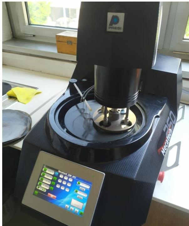
*Slika 29. Stroj tijekom brušenja*
