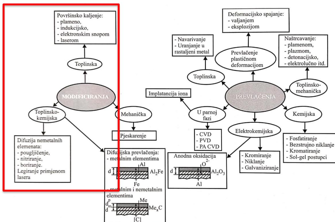
Slika 14. Shematski prikaz podjele modifikiranja i prevlačenja površina [11]
