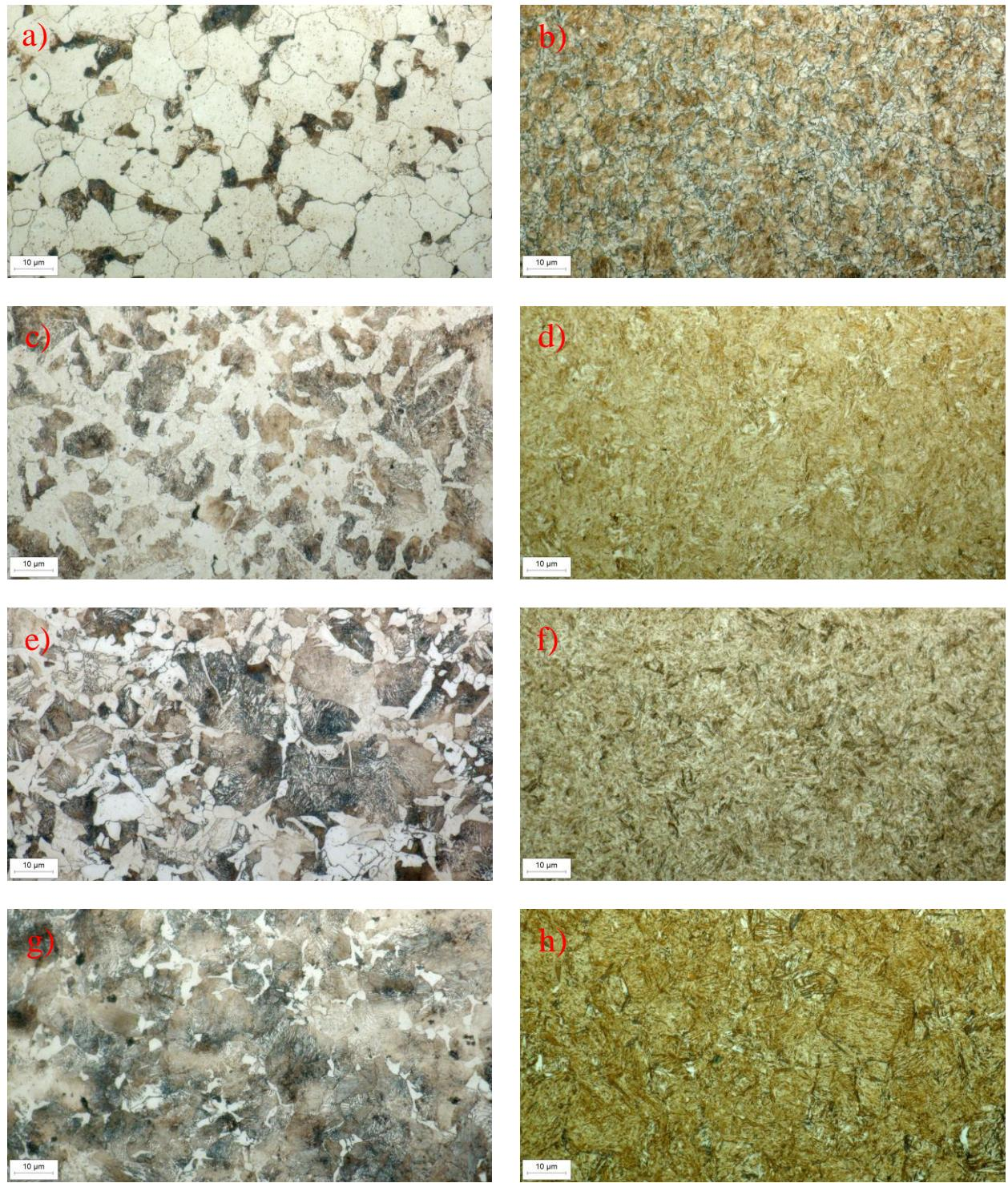
Slika 40. Mikrostrukture ispitnih uzoraka nakon provedenih toplinskih obrada (uvećanje 500x)
