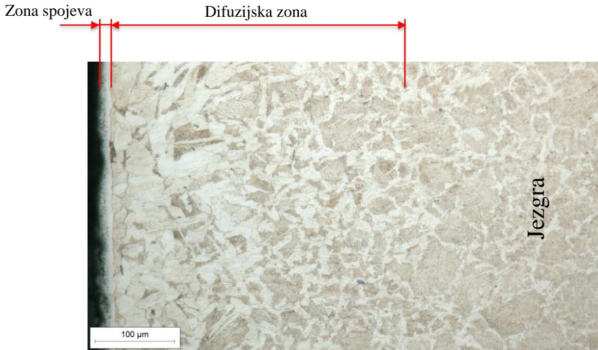
Slika 42. Mikrostruktura uzorka obrađenog tenifer postupkom (uvećanje 200x)
