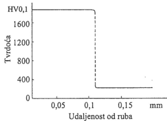
Slika 266. Raspored tvrdoća na boriranom čeliku bez „mekog jarka“ [13]
