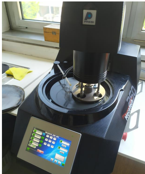
Slika 29. Stroj tijekom brušenja
