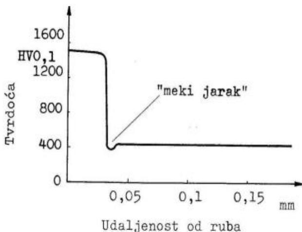
Slika 265. Rasopored tvrdoća boriranom uzorku čelika Č 4751 [13]
