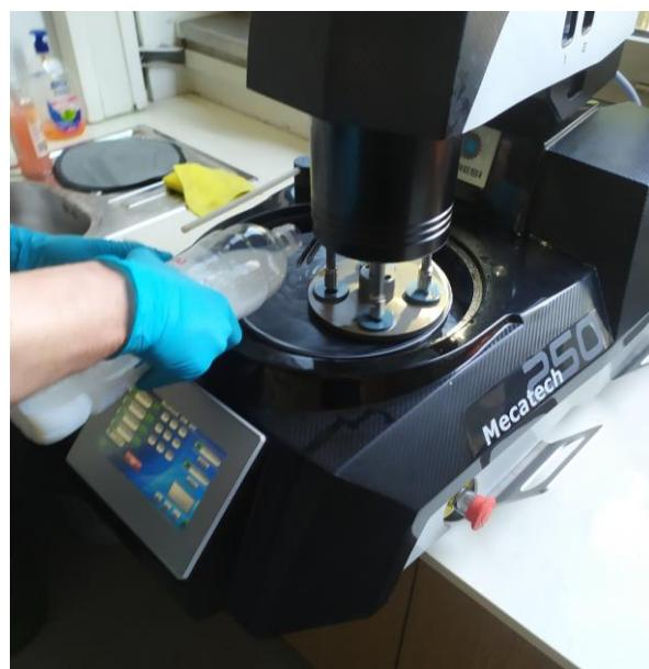
*Slika 31. Ručno dodavanje SHIP-a tijekom poliranja*
