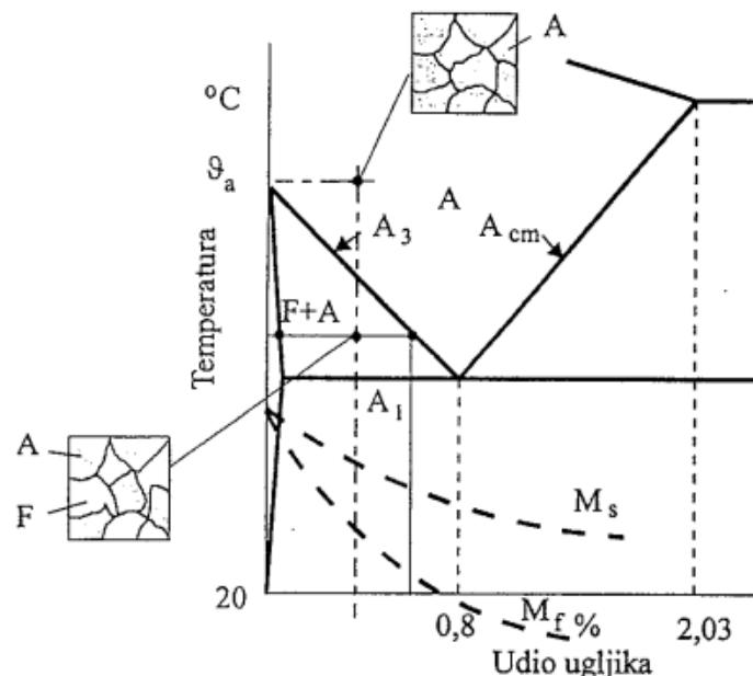
Slika 5. Određivanje temperature austenitizacije kod podeutektoidnog čelika [1]
