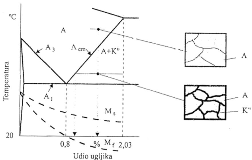
Slika 6. Određivanje temperature austenitizacije kod nadeutektoidnog čelika
