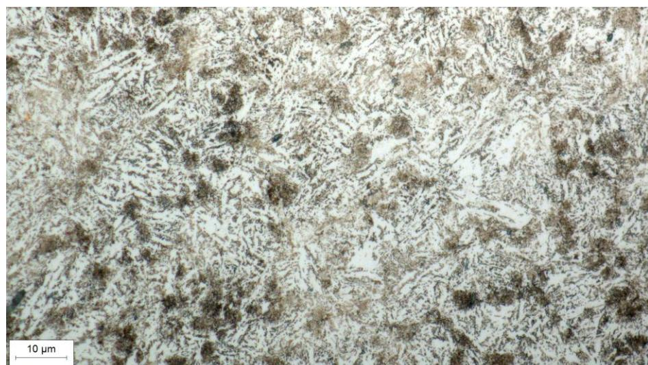
*Slika 45. Mikrostruktura jezgre i površinskog sloja induksijski kaljenog uzorka (uvećanje 500x)*
