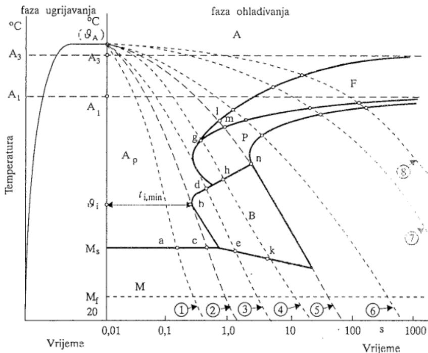
Slika 7. TTT dijagram za podeutektoidni čelik [1]
