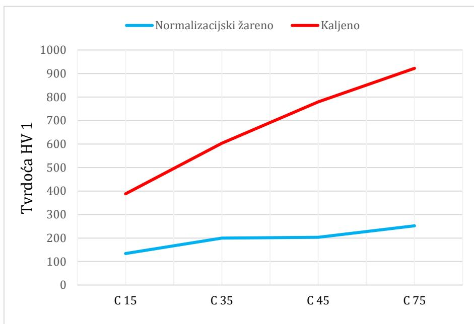
Slika 41. Tvrdoća uzorka u normaliziranom i kaljenom stanju
