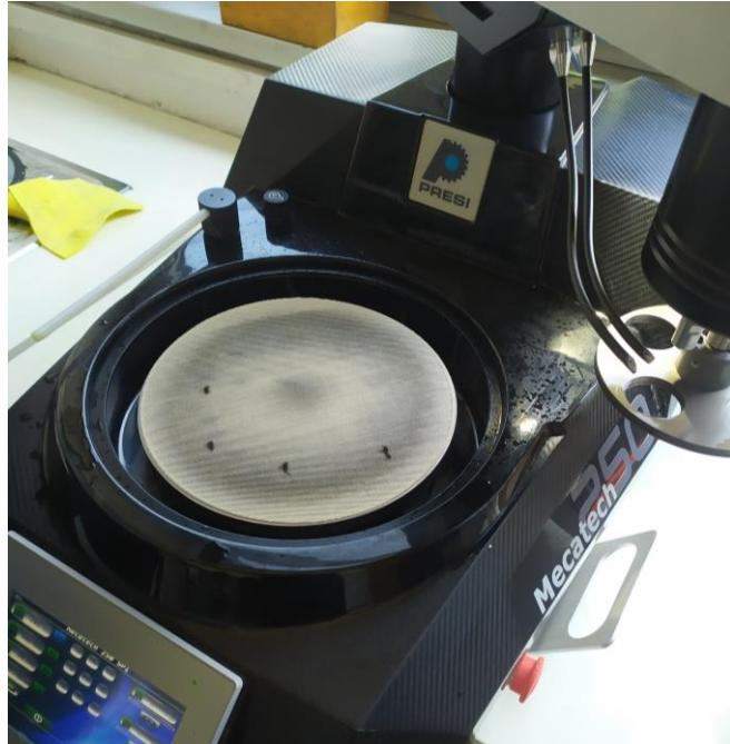
*Slika 32. Nanošenje paste za poliranje*
