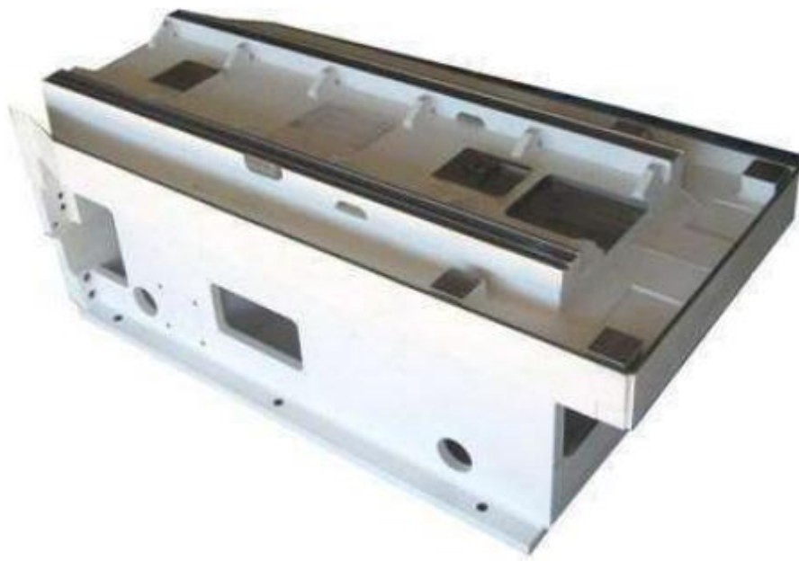
Slika 5 Zavarena izvedba postolja stroja [1]
