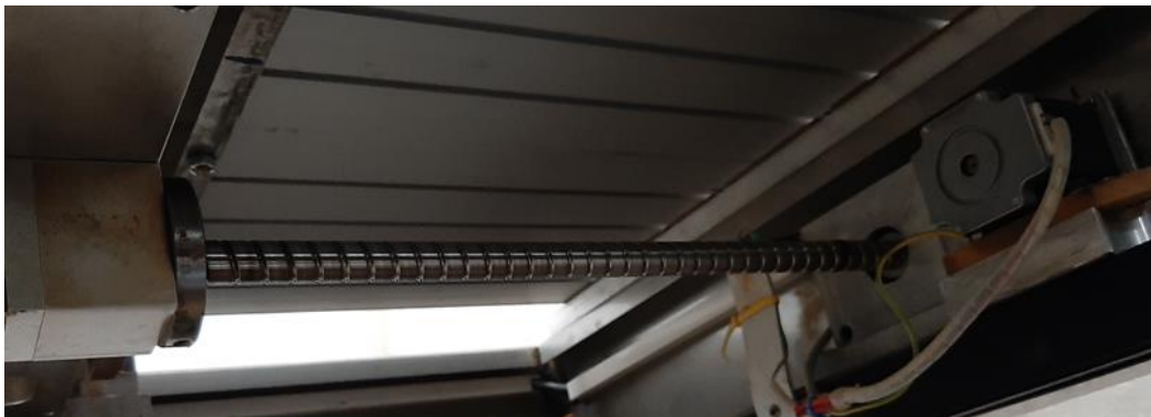
Slika 22 Navojno vreteno za x-os
