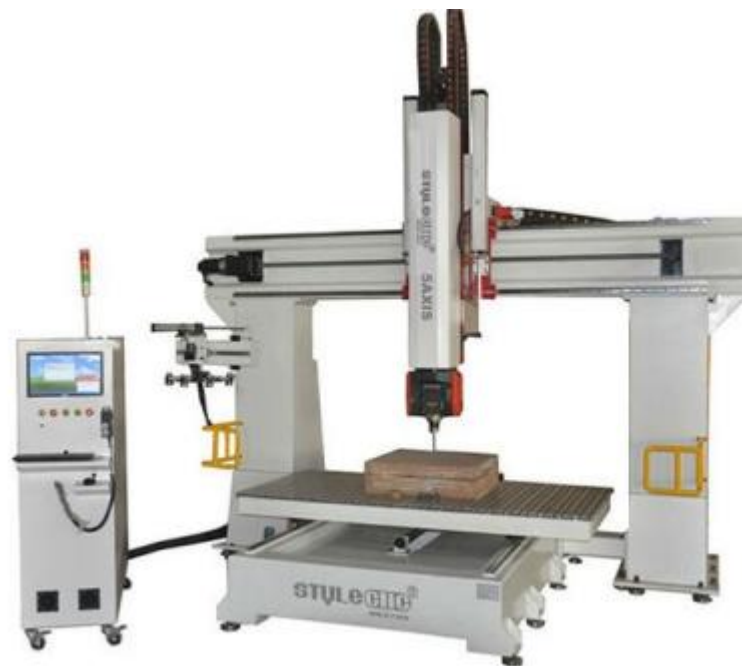
Slika 1 Profesionalni CNC gravirni stroj [3]
