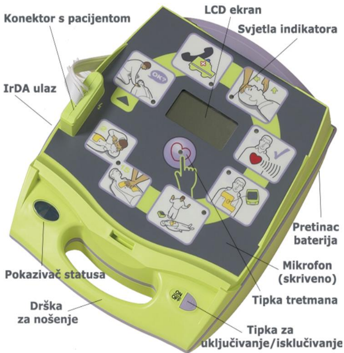
Slika 1.8.1. Kontrolne funkcije i pokazivači AVD uređaja
