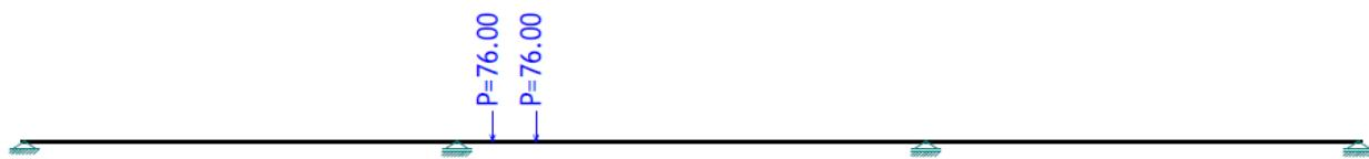
13. Pokretno opterećenje od vozila u drugom polju –  $\frac{1}{4}$  m od lijevog ležaja
