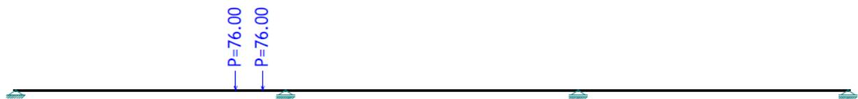
12. Pokretno opterećenje od vozila u drugom polju – 1 m od lijevog ležaja
