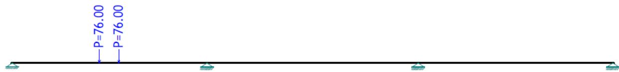
11. Pokretno opterećenje od vozila u prvom polju – 1 m od desnog ležaja
