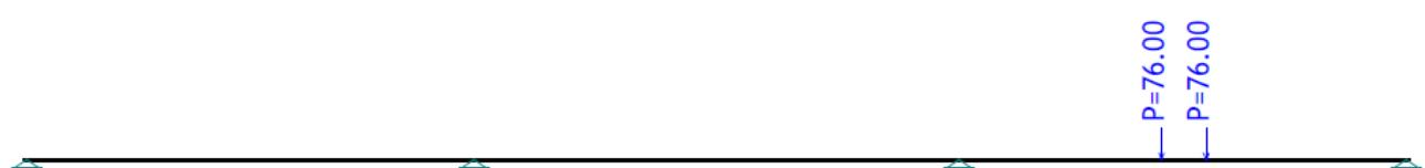
19. Pokretno opterećenje od vozila u trećem polju – 1 m od desnog ležaja
