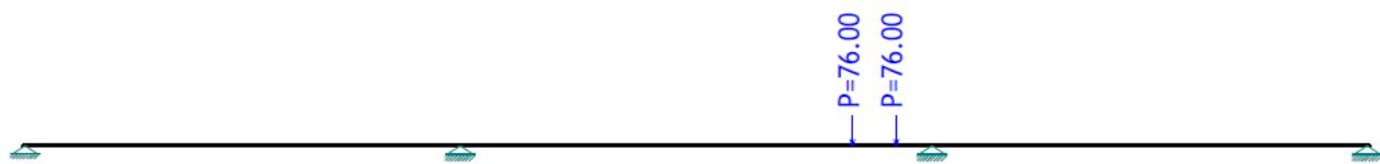
17. Pokretno opterećenje od vozila u trećem polju – 1 m od lijevog ležaja
