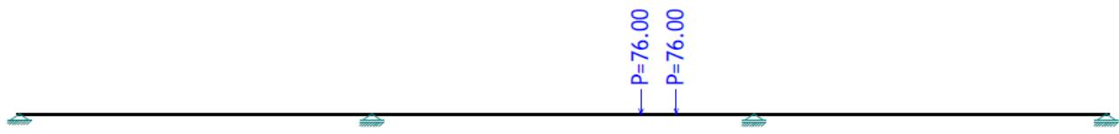
16. Pokretno opterećenje od vozila u drugom polju – 1 m od desnog ležaja
