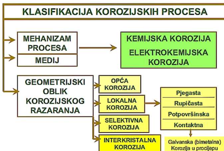
Slika 2. Klasifikacija korozijskih procesa [24]
