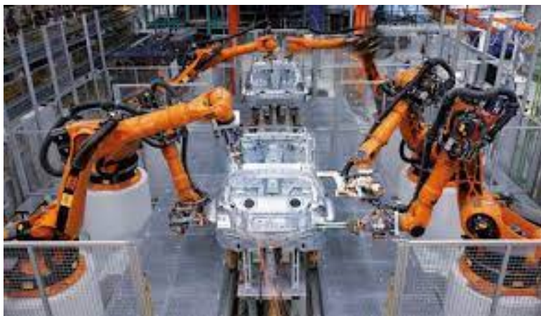
Slika 17. Prikaz elektrootpornog točkastog zavarivanja u automobilskoj industriji
