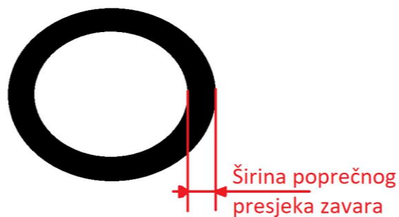
Slika 5.18 Shema izgleda zavara u tlocrtu
