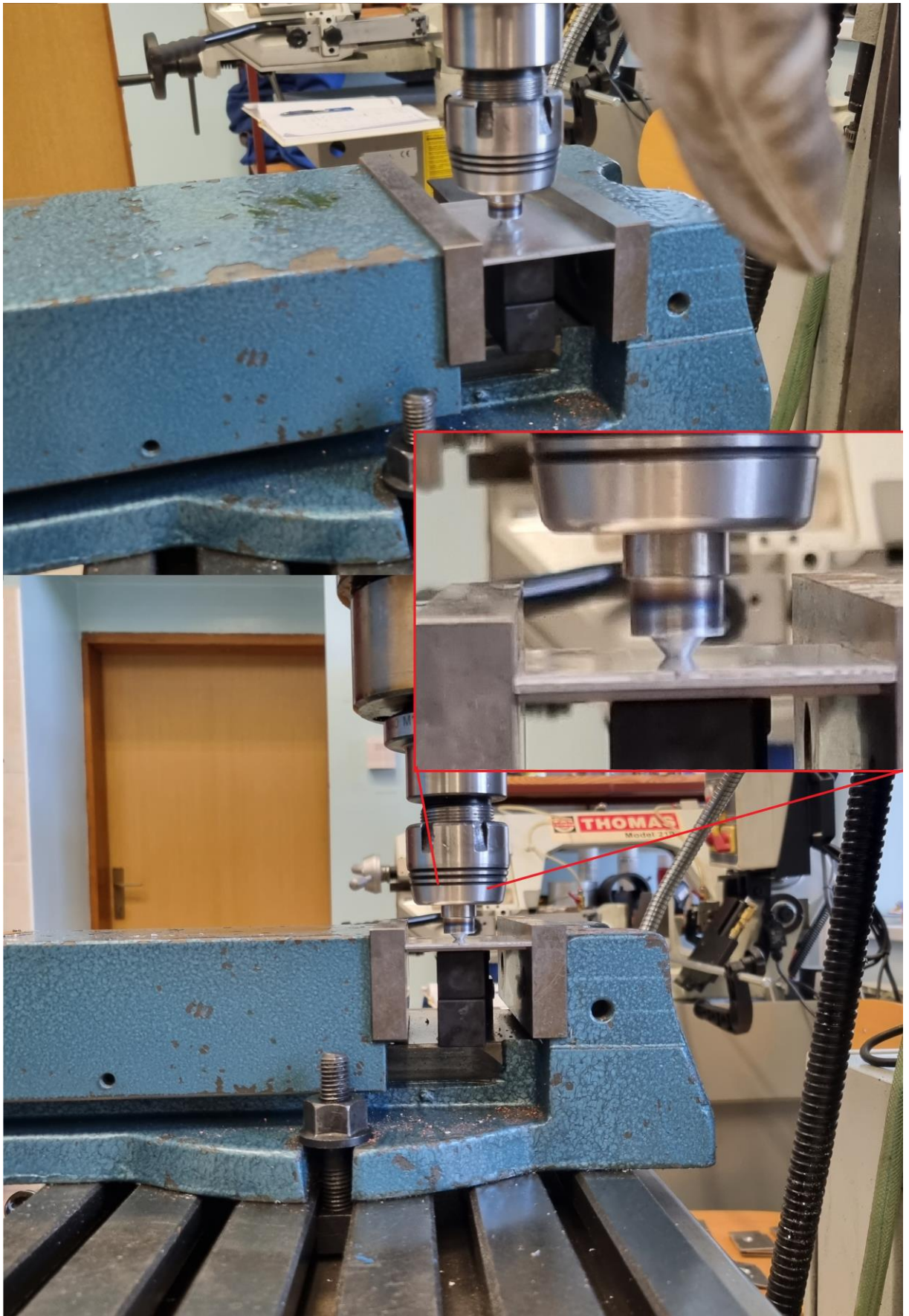
Slika 5.10 Dodir vretena s površinom uzorka
