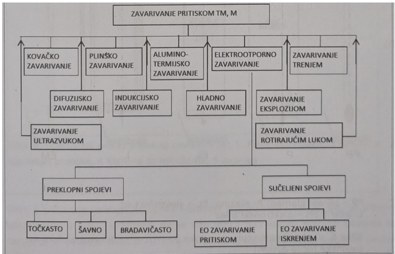
Slika 3.3 Podjela postupaka zavarivanja pritiskom [4]
