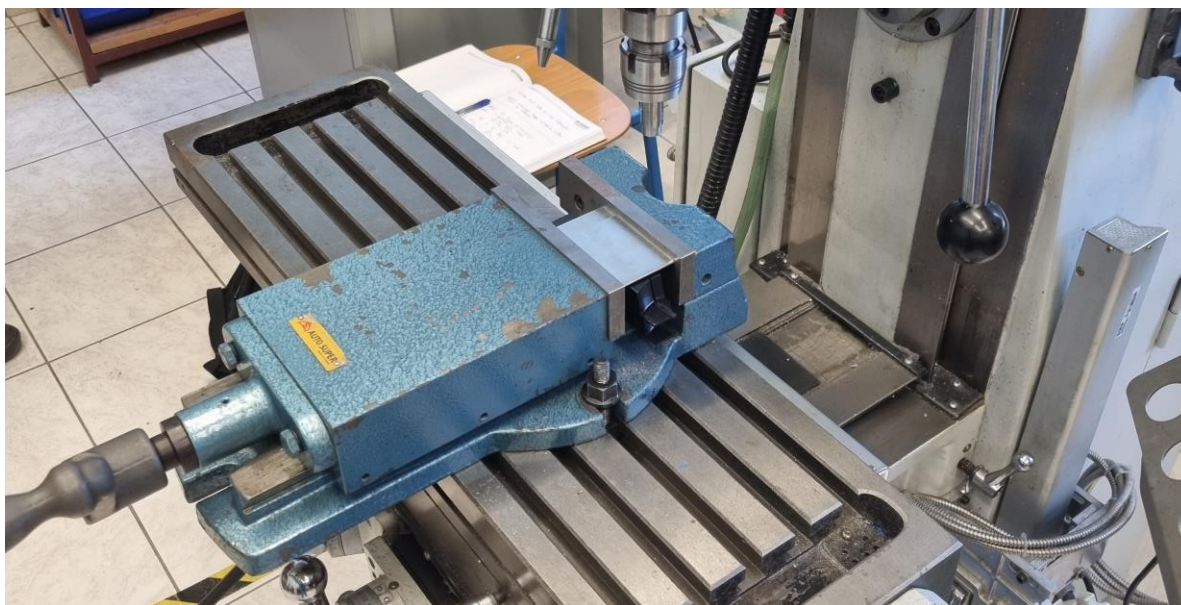
Slika 5.9 Uzorak stegnut u škripcu na glodalici
