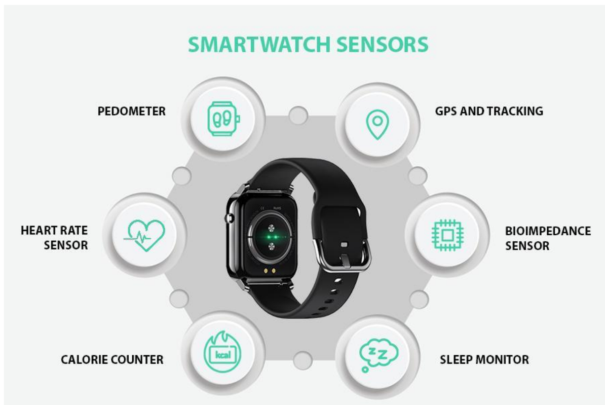
Slika 3.1.8. 1 Senzori na pametnim satovima
