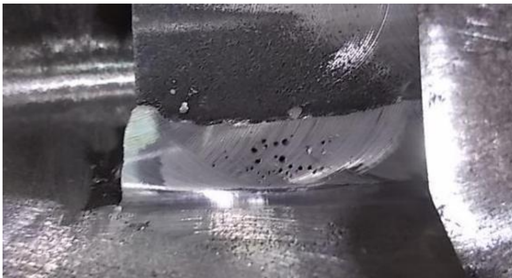
Slika 3.5. Poroznost u zavarenom spoju [16]
