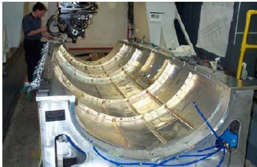
Slika 4.15. Zavarivanje stranica zrakoplova FSW postupkom [23]
