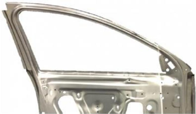
*Slika 4.16. Okvir vrata automobila izrađen pomoću FSW postupka [27]*
