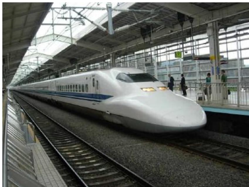
Slika 4.12. Putnički vlak proizveden pomoću FSW postupka [23]
