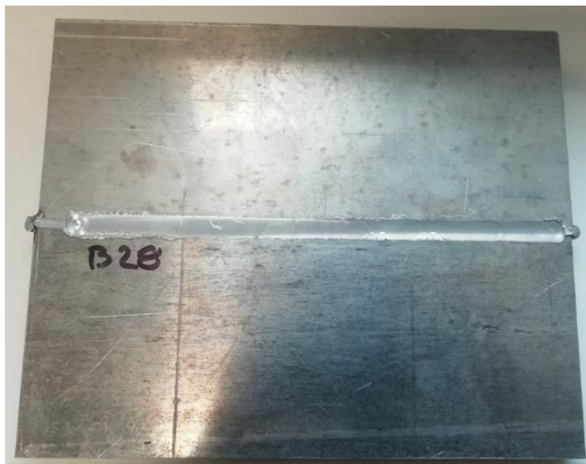
Slika 5.8. Zavareni spoj aluminijskih sendvič panela izrađen zavarivanjem trenjem rotirajućim alatom
