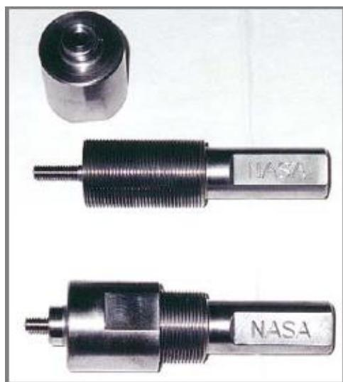
Slika 4.4. Alat za FSW postupak [5]
