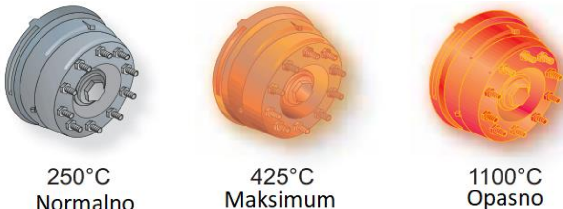
Slika 1. Izgled kočionih bubnjeva kod zagrijavanja [1]
