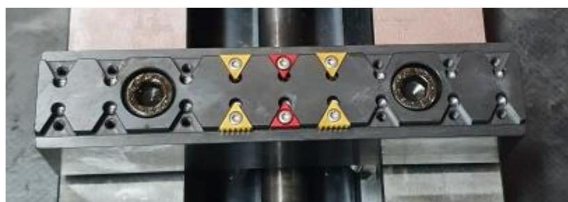
Slika 25 Čeljust za dvostruko stezanje
