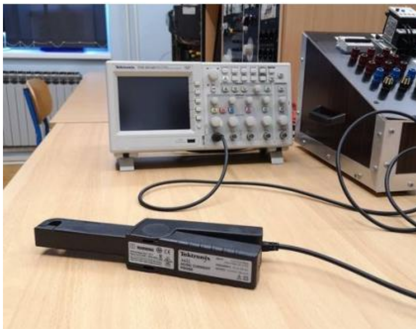
Slika 25. Osciloskop Tektronix TDS 2014B sa strujnim kliještima
