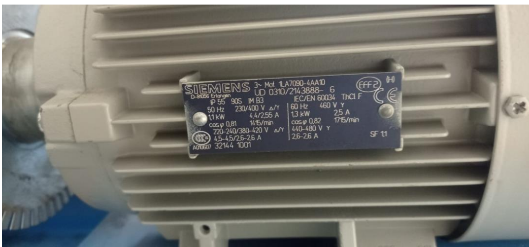
Slika 20. Pločica sa specifikacijama Siemens motora
