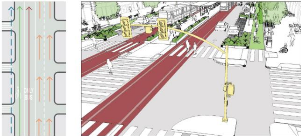
Slika 27 Smirenje prometa pomoću prilagodbe promjene signala na semaforu
