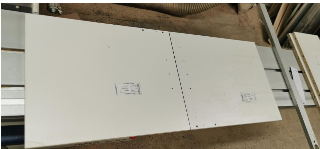
Slika 11: Provjera bušenja i pozicija kantova
