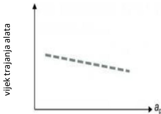
Slika 9.12 Dubina rezanja ima mali utjecaj na vijek trajanja alata [17]
