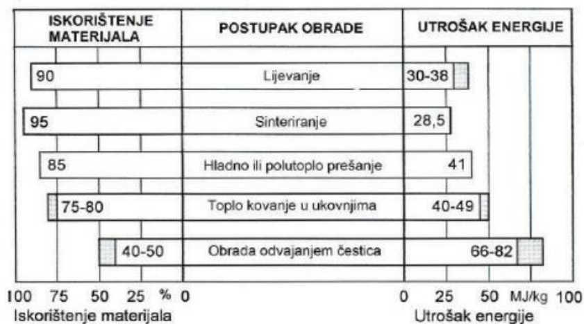
Slika 5.3 Iskorištenje materijala kod pojedinih postupaka obrade [6]
