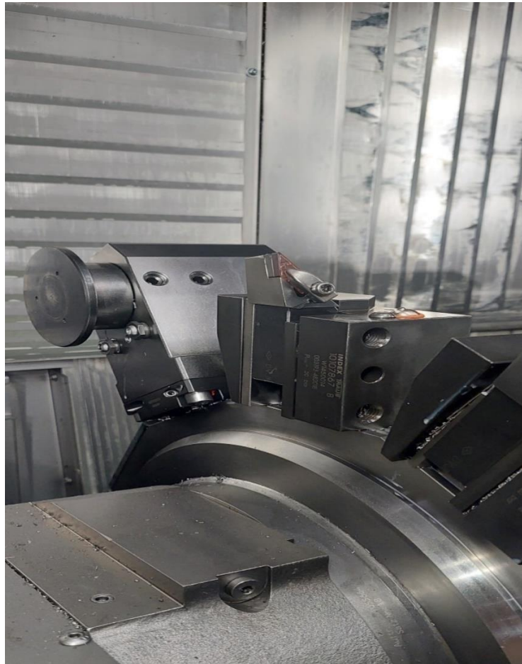
Slika 6.8 Držač „570-DVUNL-40-16“ i pločica „VNMG 16 04 08-MM 1125“
