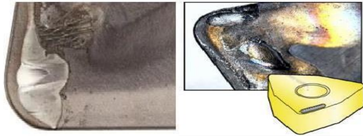
Slika 9.18 Izgled i položaj kraterskog trošenja [10]
