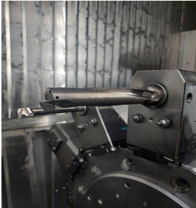
Slika 6.4 Držač, obodna i centralna pločica za bušenje
