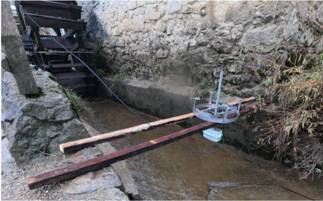
Slika 55. Mjerenja sa SQ-R Flow Meter [17]
