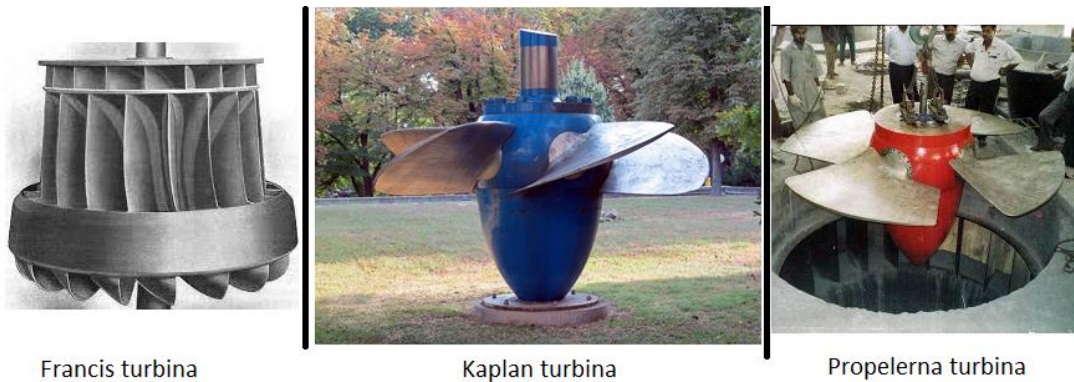
Slika 2. Vrste reakcijskih turbina [3]
