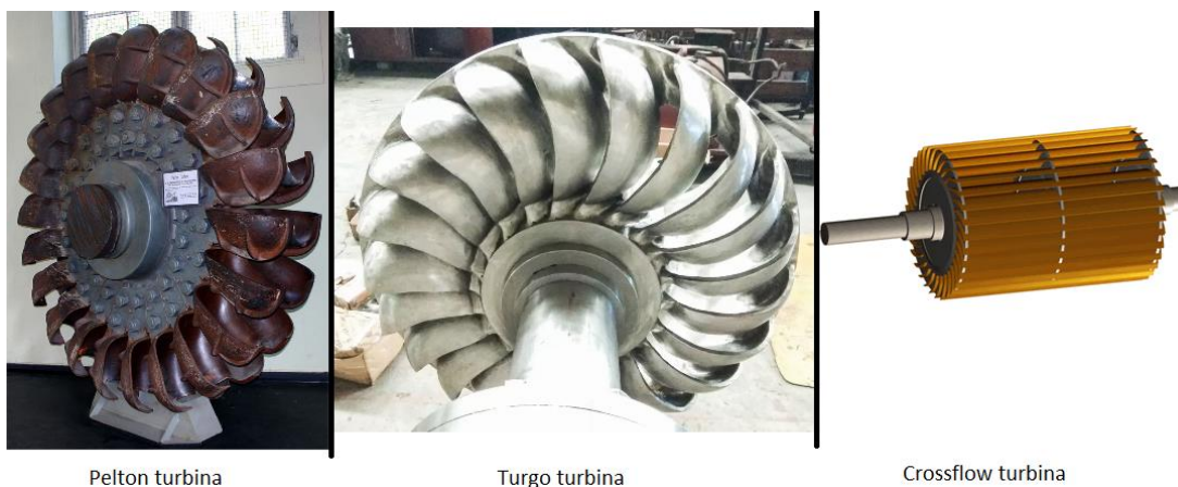
Slika 4. Vrste akcijskih turbina [3]
