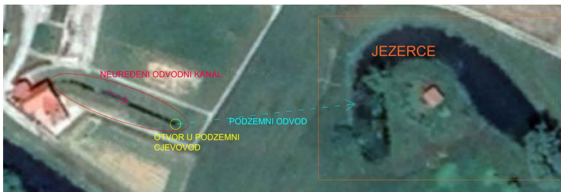
Slika 31. Shematski prikaz odvodnje vode od vodnog kola do jezera [22]
