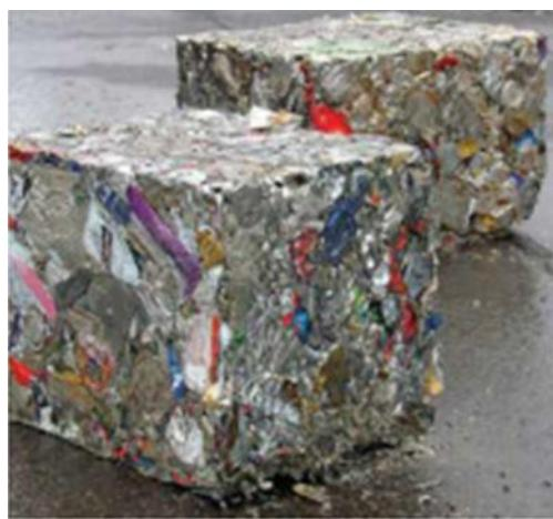
Slika 5.2: Snop čelične ambalaže s primjesama nečistoće
