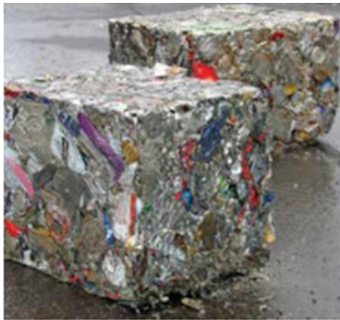
Slika 5.2: Snop čelične ambalaže s primjesama nečistoće
