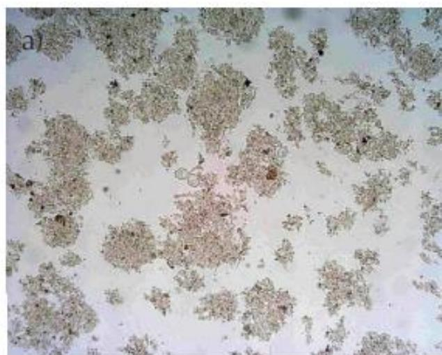
Slika 3.4. Mikrofotografija pahuljica aktivnog mulja, P=100x [13]
