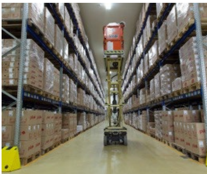
Slika 18. Čeoni električni visokopodizni viličar u skladištu mesne industrije PIK Vrbovec[15]
