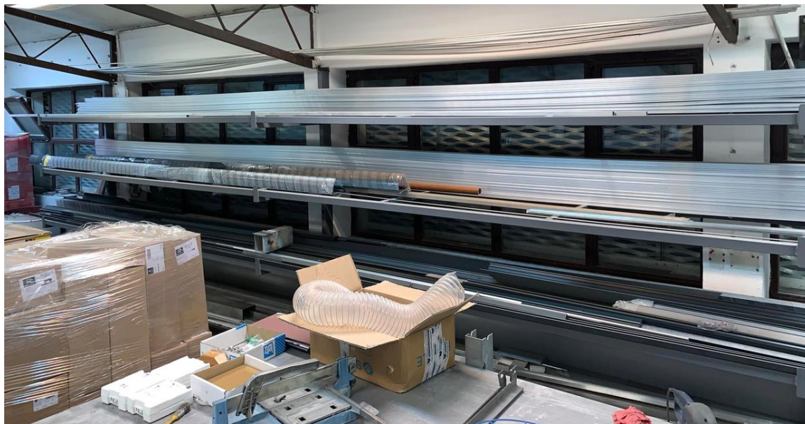
Slika 2.4. Primjer konzolnog regala
