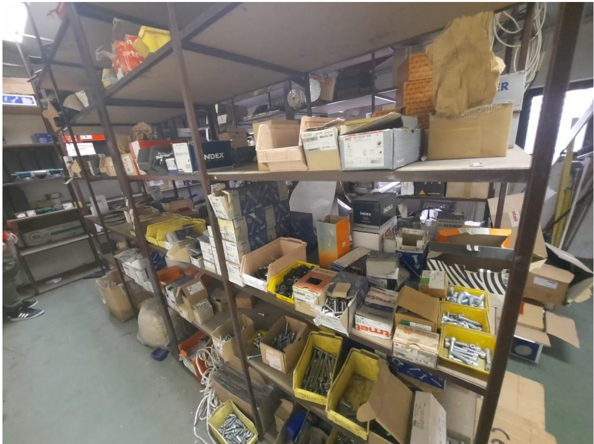
Slika 2.1. Skladištenje sitnog materijala pomoću poličnih skladišnih regala
