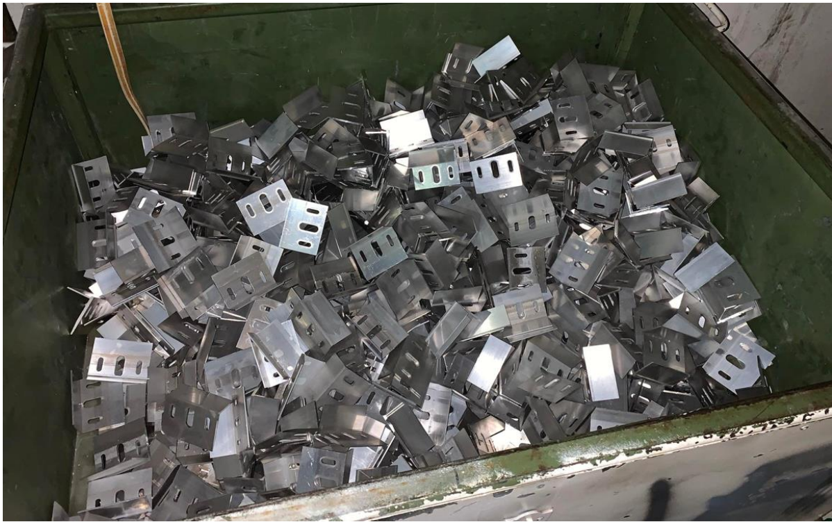
Slika 1.8. Aluminijske baze sidra
