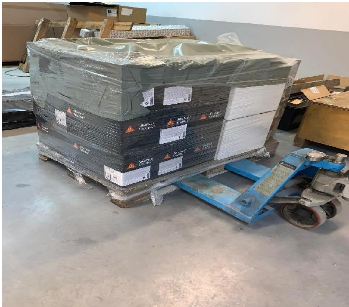
Slika 2.7. Upotreba ručnog viličara u procesu unutarnjeg transporta
