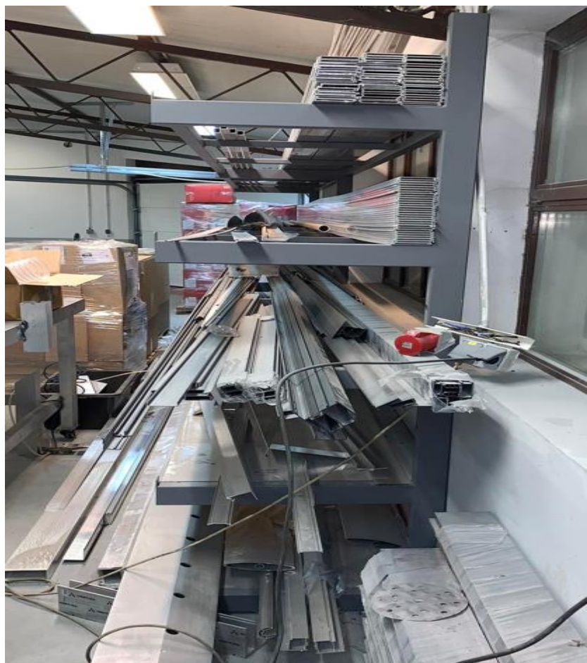
Slika 2.5. Bočni prikaz konzolnog regala sa aluminijским profilima
