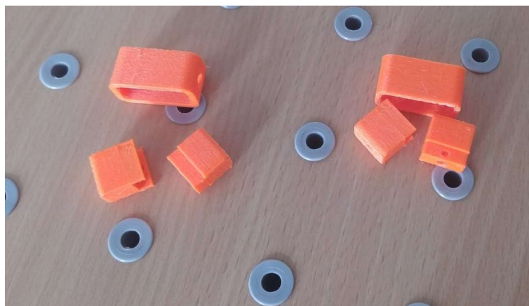
Slika 19. Vakuum generator u dijelovima nakon ispisa
