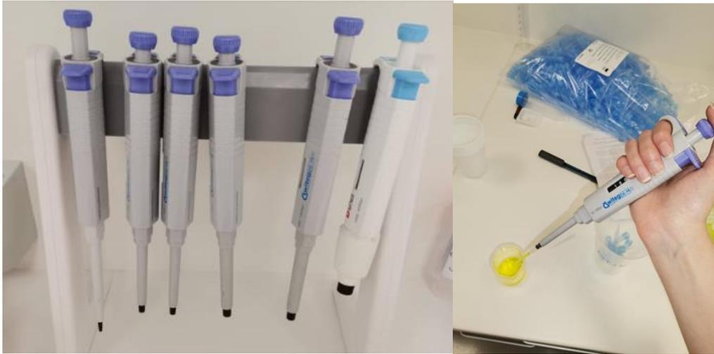
Slika 13: Pipete (lijevo) i doziranje FC reagensa (desno)
