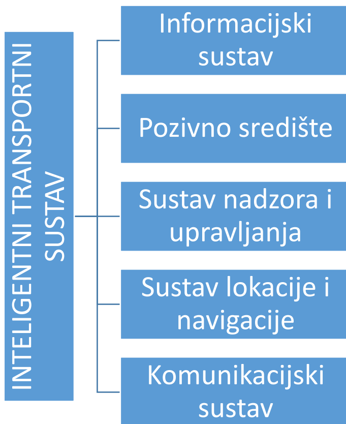
Slika 2. Prikaz podsustava inteligentnog transportnog sustava
