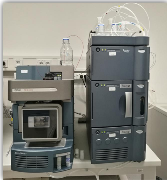
Slika 9: Korišteni LC-MS/MS sustav: Acquity H-classXevo TQ-S micro. Izvor: Waters, SAD
