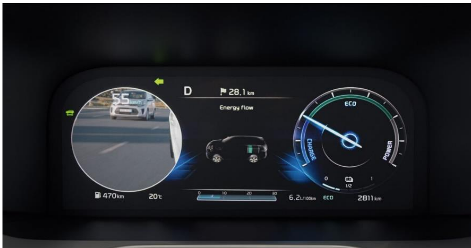
Slika 6 Prikaz pomoći za vozačev mrtvi kut
