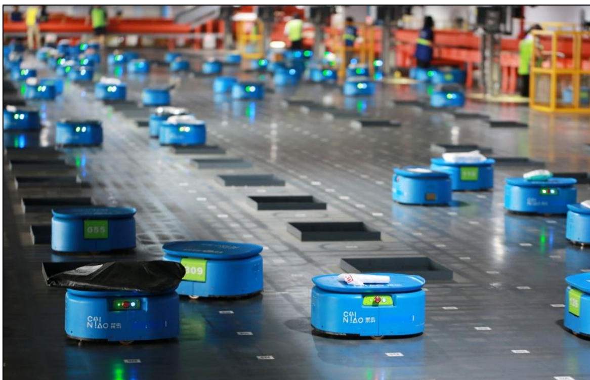
Slika 4.10. Skladišna teretna robotska vozila
