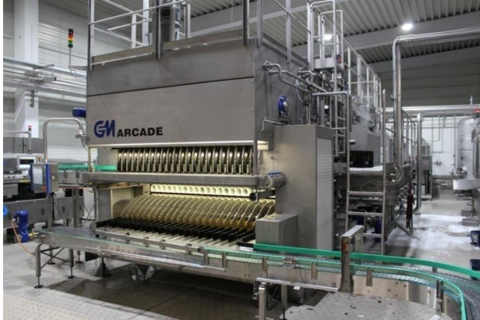
Slika 3. Stroj za pranje staklenih boca [19]
