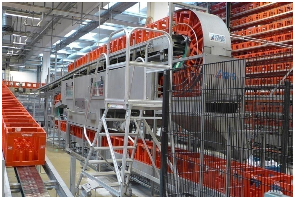
Slika 4. Stroj za pranje sanduka [19]
