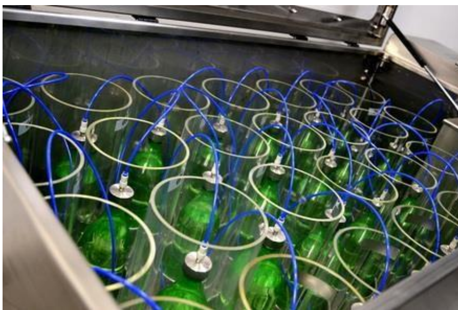
Slika 13. Crack test PET boca [Izvor: Martin Božurić]
