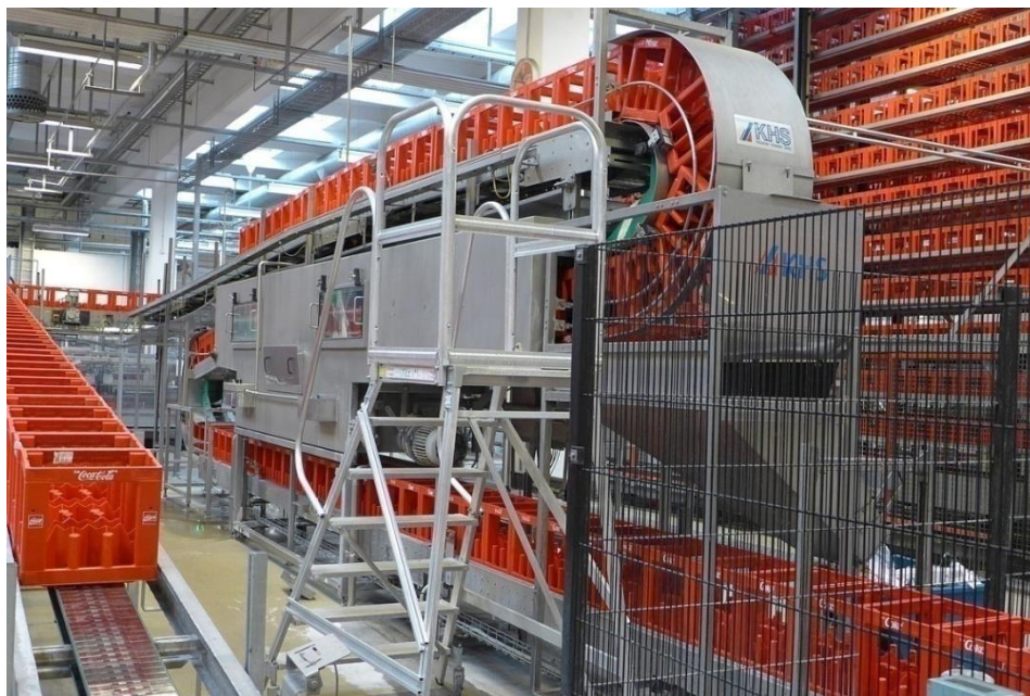
Slika 4. Stroj za pranje sanduka [19]
