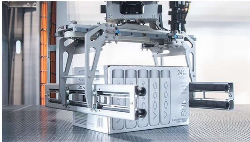
Slika 1. Depaletizator i paletizator [19]
