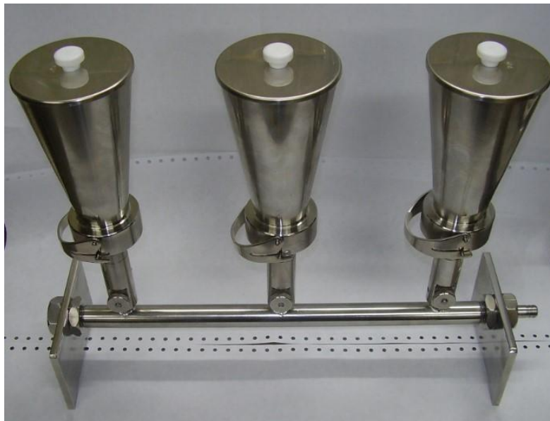
Slika 16. Uređaj za membransku filtraciju [22]
