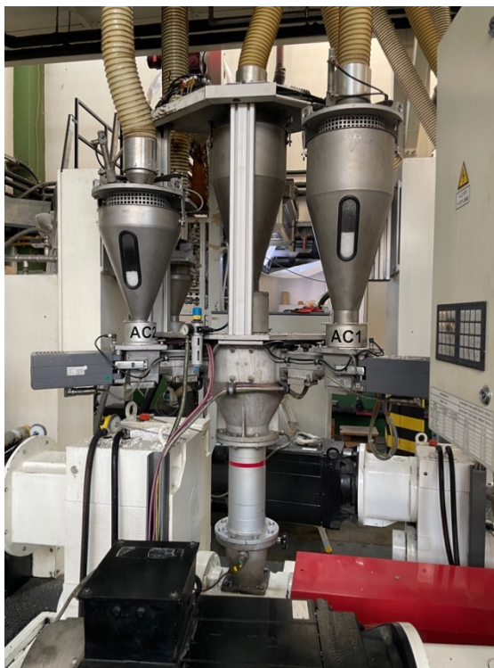
Slika 11. Dio ekstrudera u kojem se tali polietilen
