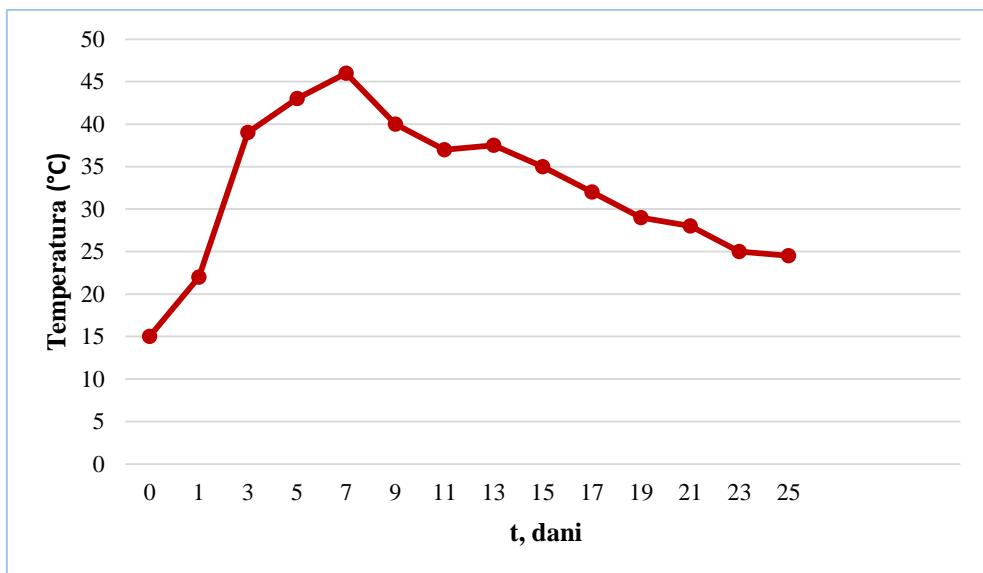
**Slika 42.** Rezultati mjerjenja temperature kompostne mase tijekom procesa kompostiranja
