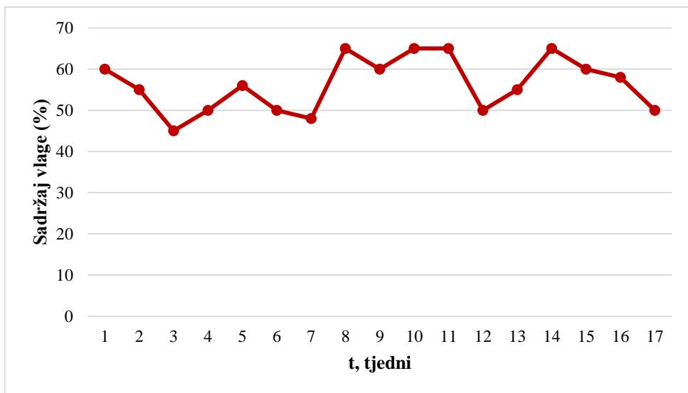
**Slika 41.** Rezultati mjerjenja vlažnosti kompostne mase tijekom procesa kompostiranja
