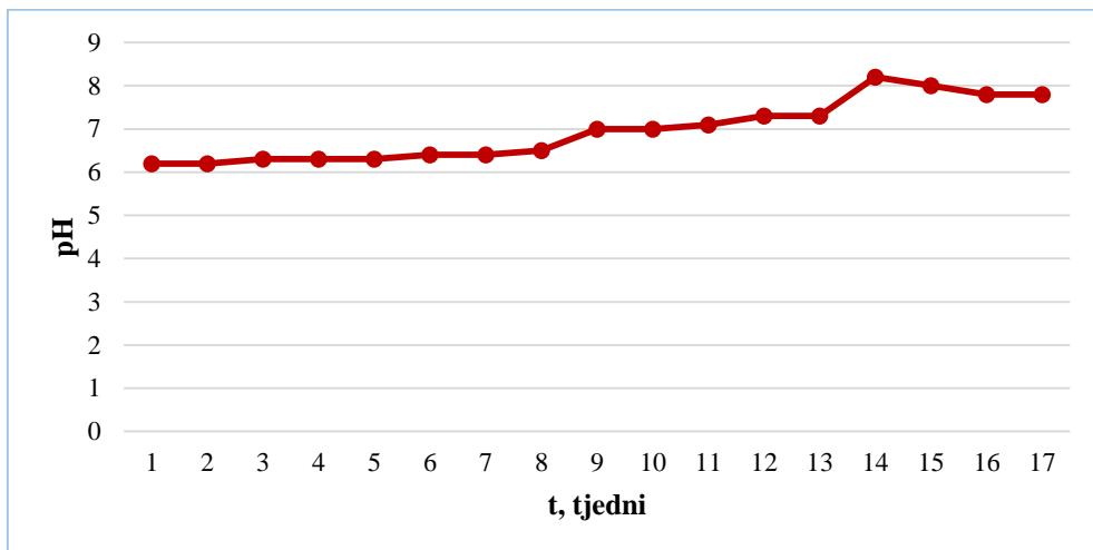
**Slika 43.** Rezultati mjerjenja pH vrijednosti kompostne mase tijekom procesa kompostiranja
