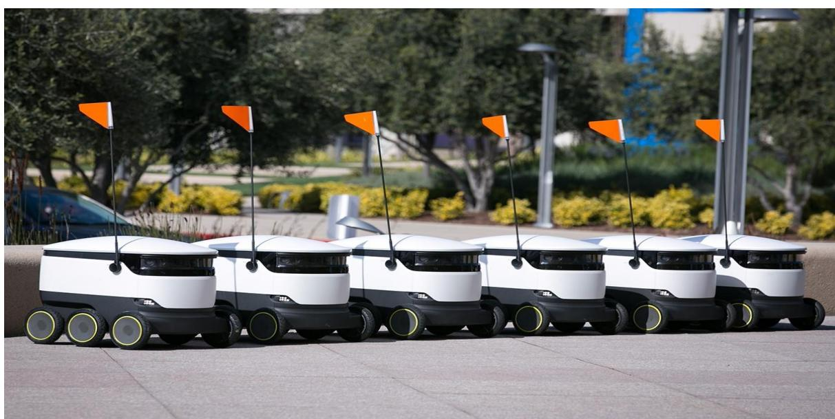
**Slika 10. Autonomni dostavni roboti tvrtke Starship Technologies**
