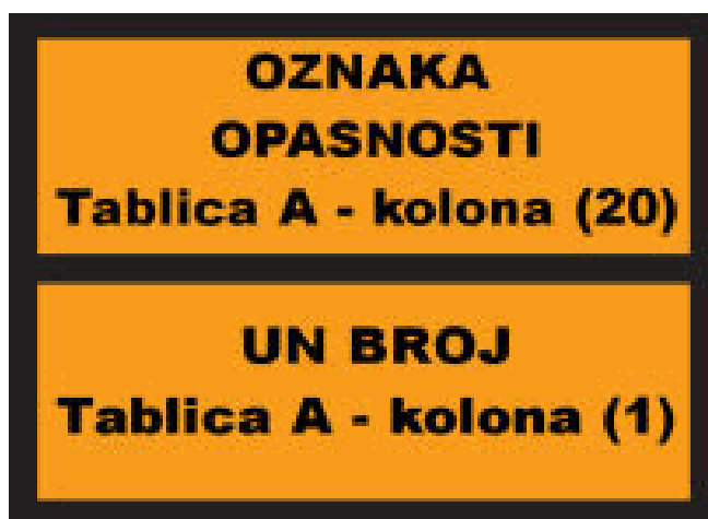
Slika 11. Ploča opasnosti s brojevima za raspoznavanje
