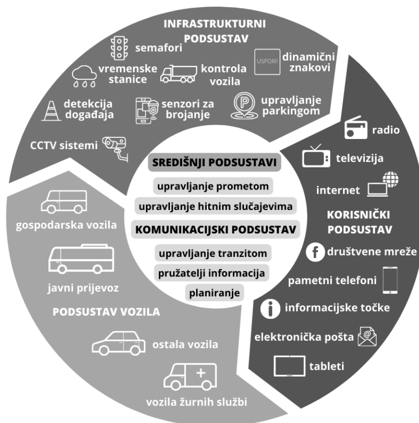
Slika 1. Konceptualni model inteligentnih transportnih sustava
