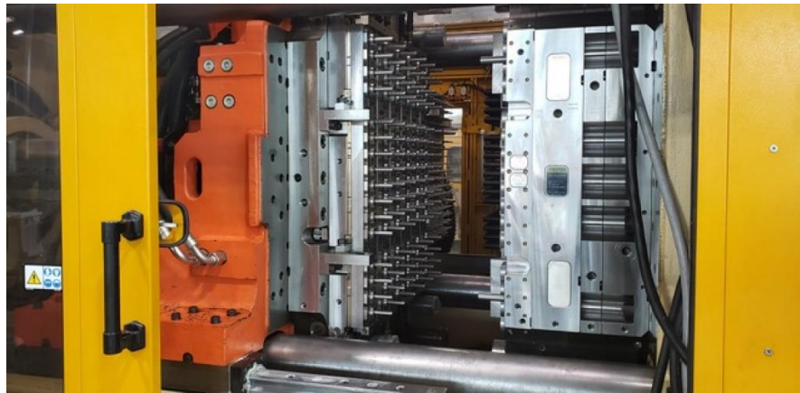
Slika 7-7: Kalup za injekcijsko brizganje
