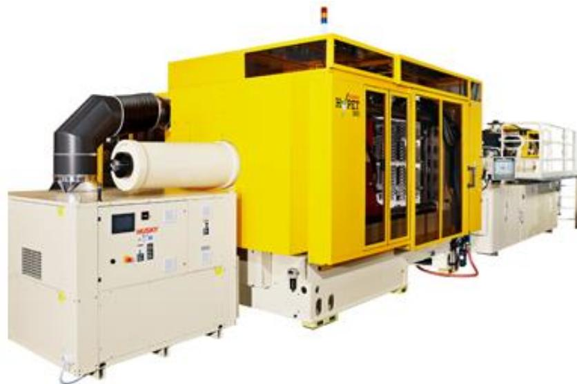
*Slika 7-6: Stroj za injekcijsko brizganje*
