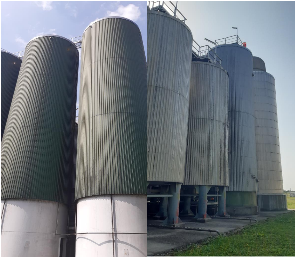
Slika 3.5 Fermentacijski i tlačni tankovi za cider; Carlsberg Croatia; Anabela Škorjanec, kolovoz 2022.
