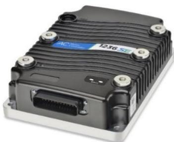
Slika 13. Kontroler motora električnog automobila
