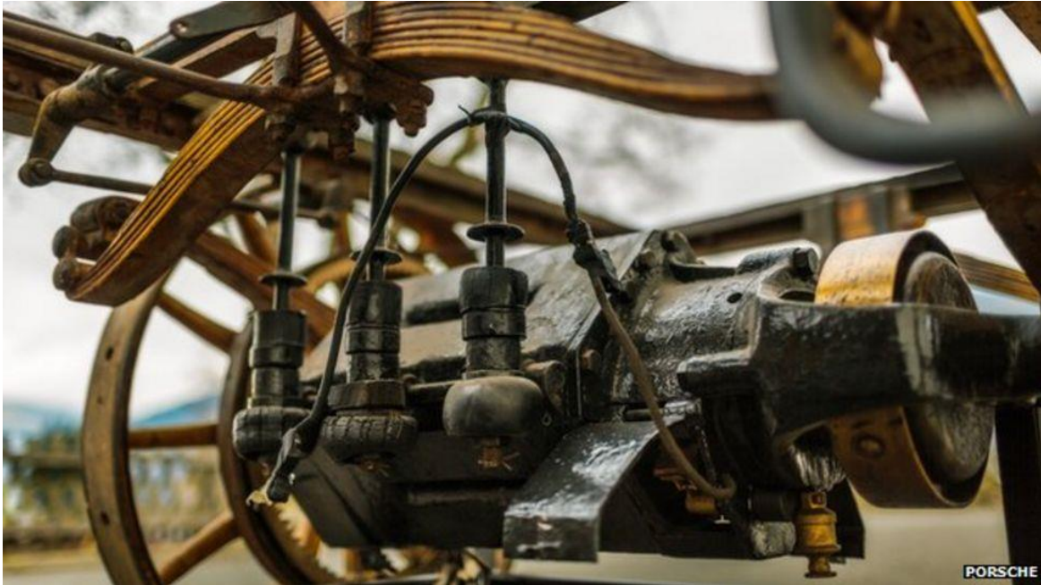
Slika 7. Osmerokutni električni motor koji je dizajnirao Ferdinand Porsche
