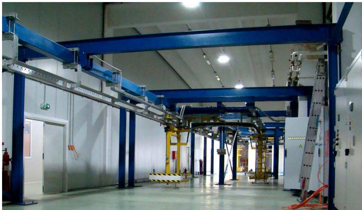
Slika 20 Vodilice koje robu od trakastih transportera vode u čelije i obratno
