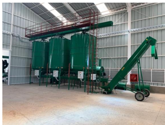
b) Moderno postrojenje za sušenje lješnjaka, izvor: https://www.agroklub.com/vocarstvo/susenje-ljesnjaka-koji-kapacitet-susare-odabrati/57518/
