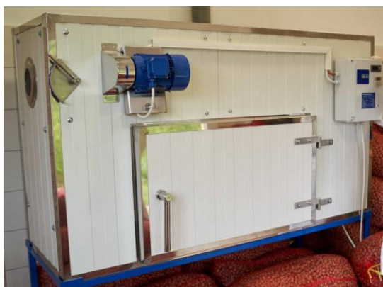
a) Sušara komornog tipa, izvor: https://www.tammy.hr/
