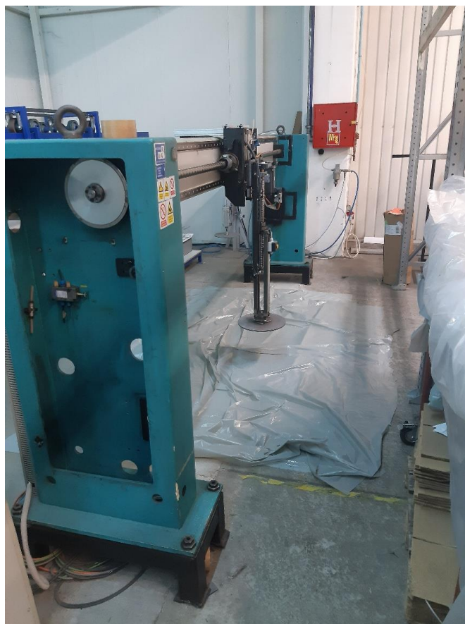
Slika 4.10.2.2 Stroj za ispitivanje čvrstoće madraca [autor]
