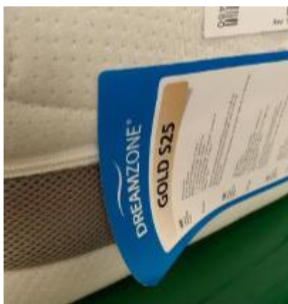
Slika 4.7.2 Primjer lošeg prianjanja etikete [8]
