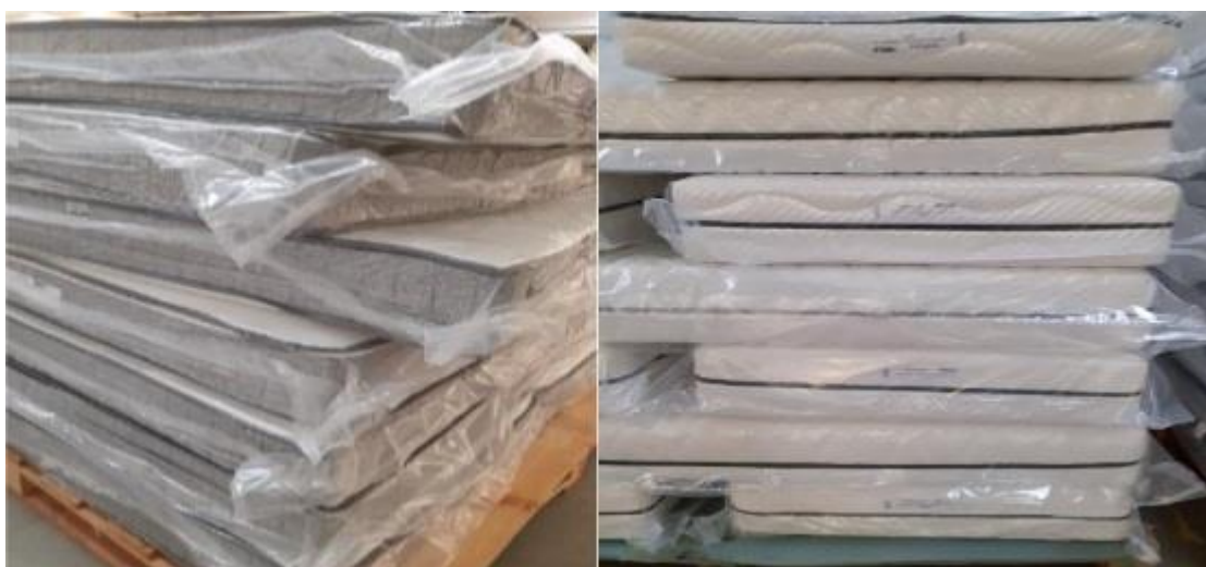
Slika 4.10.5 Primjer neispravnog slaganja na paletu (lijevo) i ispravnog (desno) [8]
