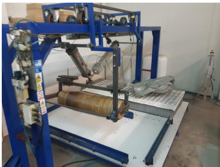
Slika 4.10.2.1 Stroj za valjanje madraca [autor]
