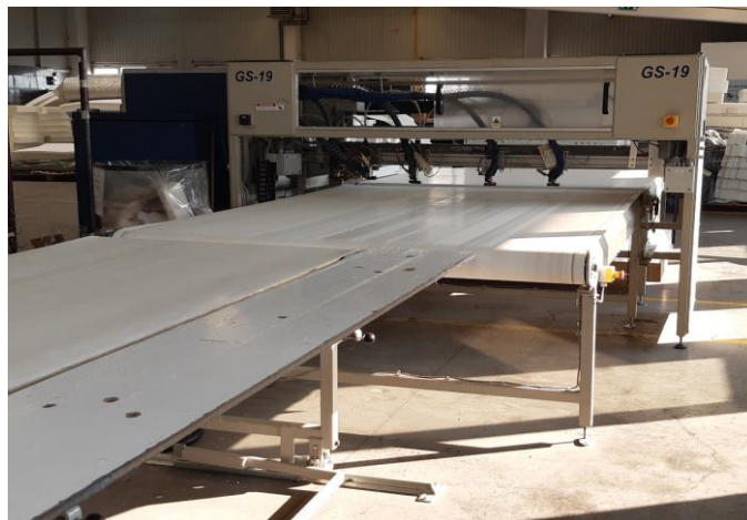
Slika 2.2. Linija za lijepljenje grijanim ljepilom [autor]
