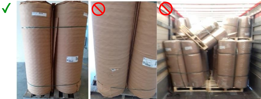
Slika 3.1.1 Primjer ispravne i oštećene ambalaže [8]
