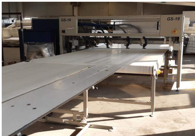
Slika 2.2. Linija za lijepljenje grijanim ljepilom [autor]
