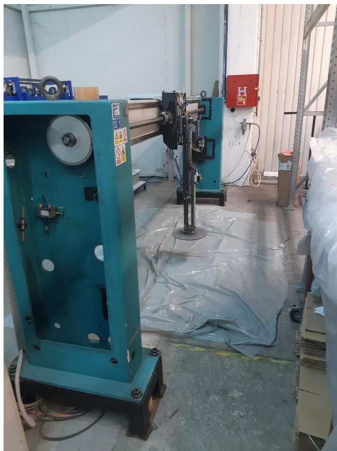
Slika 4.10.2.2 Stroj za ispitivanje čvrstoće madraca [autor]
