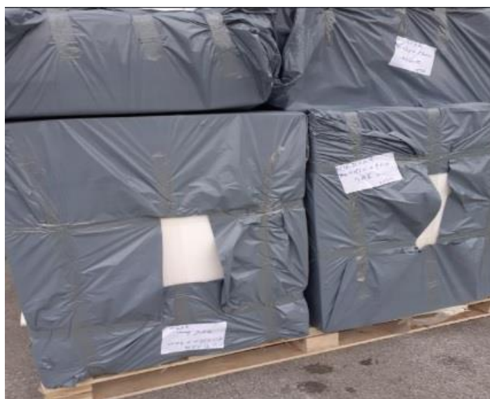
Slika 3.3.2 Primjer neispravno zapakirane pjene [8]
