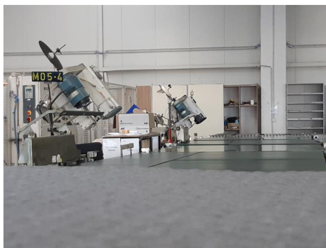
Slika 2.1.6 Tape edge šivaće mašine [autor]
